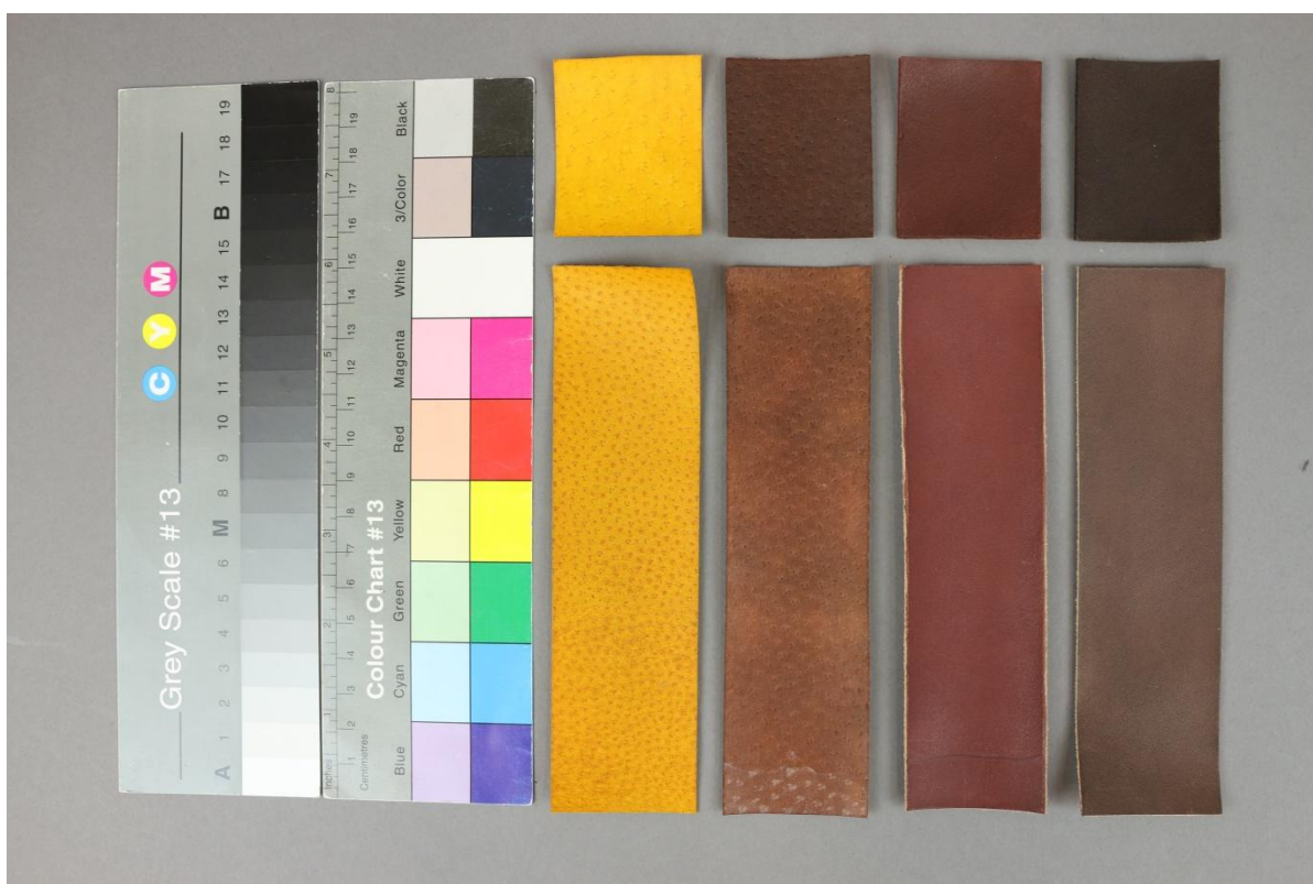
Obr. č. 32: Fiebing's Professional Oil Dye, vzorky před stárnutím
