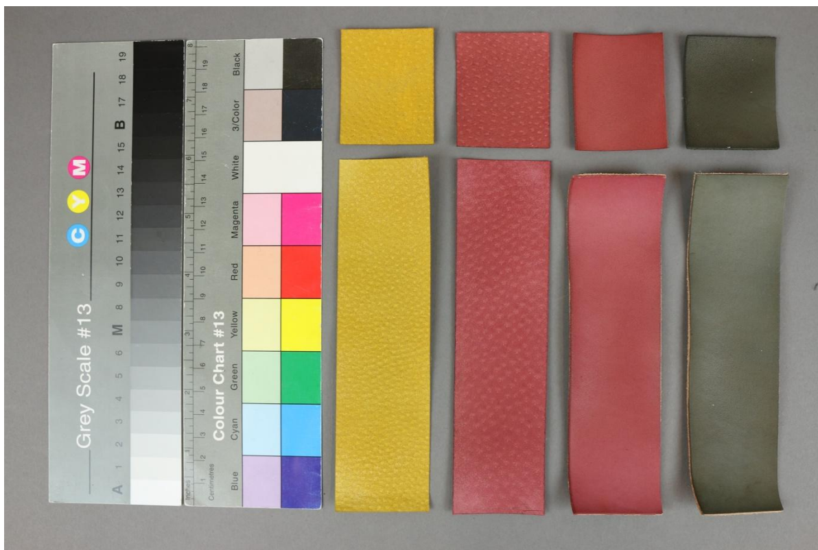
Obr. č. 36: Lihové mořidlo Chemoxyl, vzorky před stárnutím
