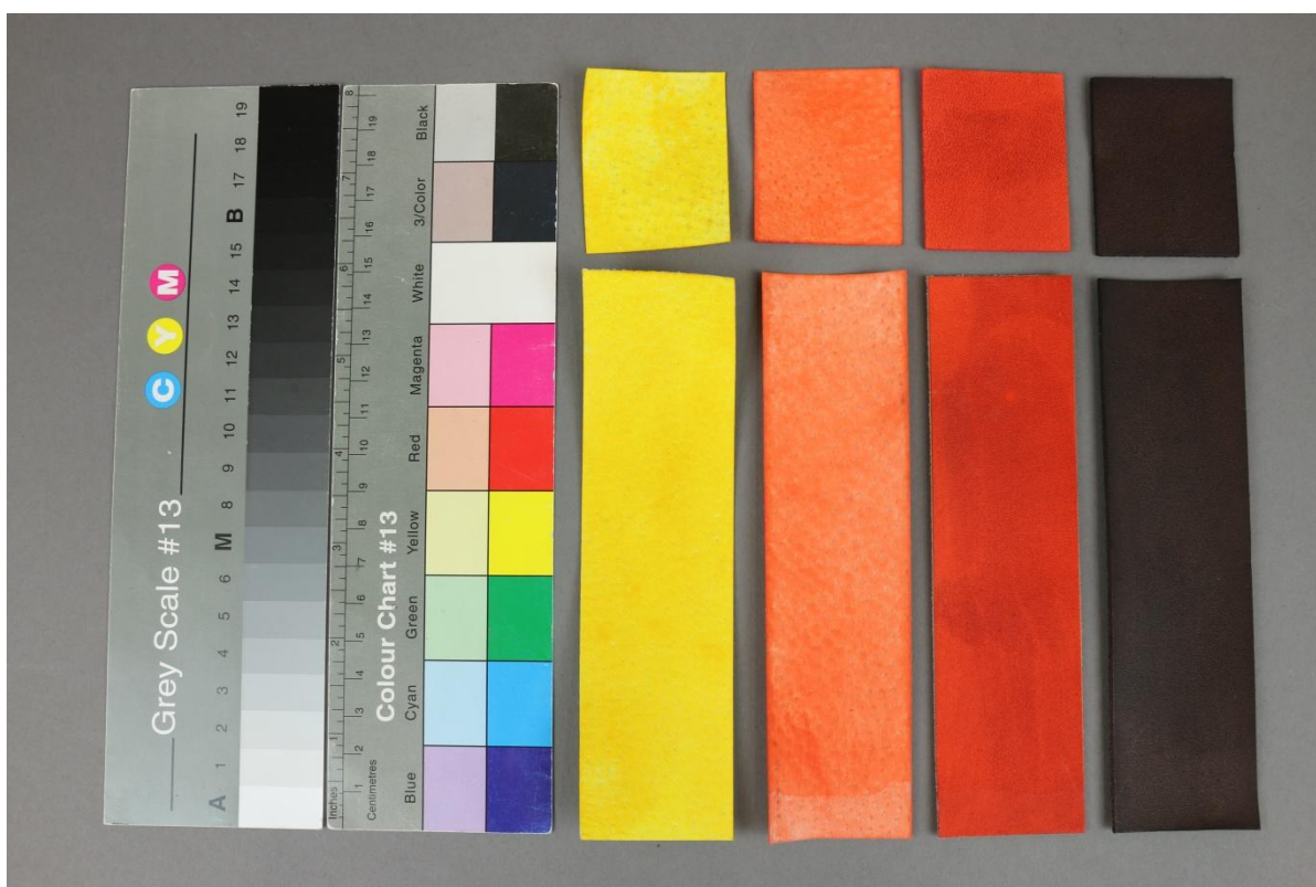
Obr. č. 40: J Hewit & Sons Ltd Leather Dye Powder, vzorky před stárnutím
