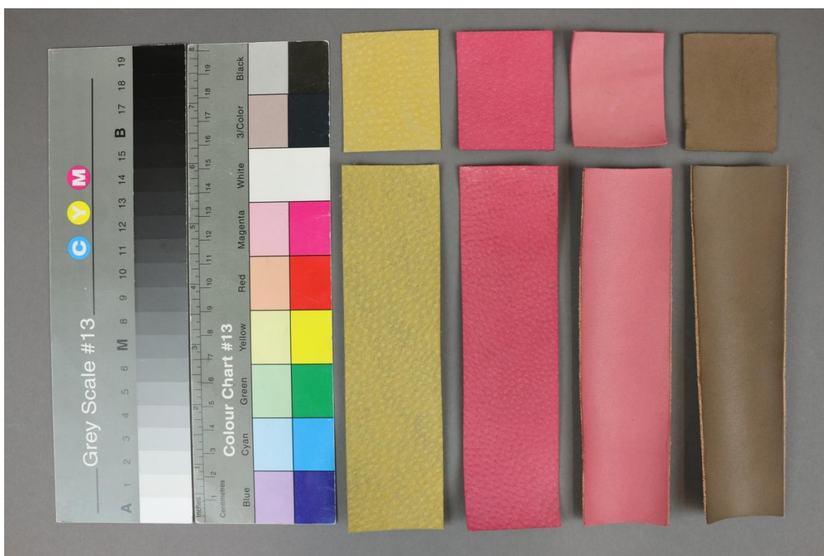
Obr. č. 42: Lihové mořidlo Druchema, vzorky před stárnutím
