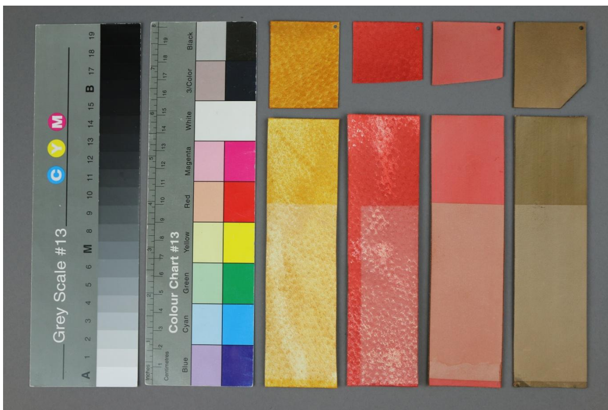
Obr. č. 45: Sellaset Leather Dye, vzorky po stárnutí v QUV panelu
