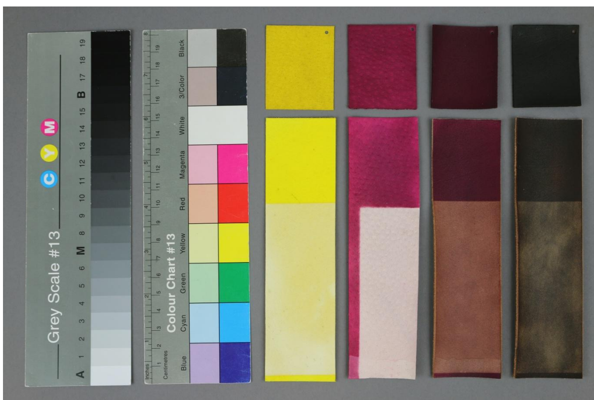
Obr. č. 29: Fiebing's Leather Dye, vzorky po stárnutí v QUV panelu
