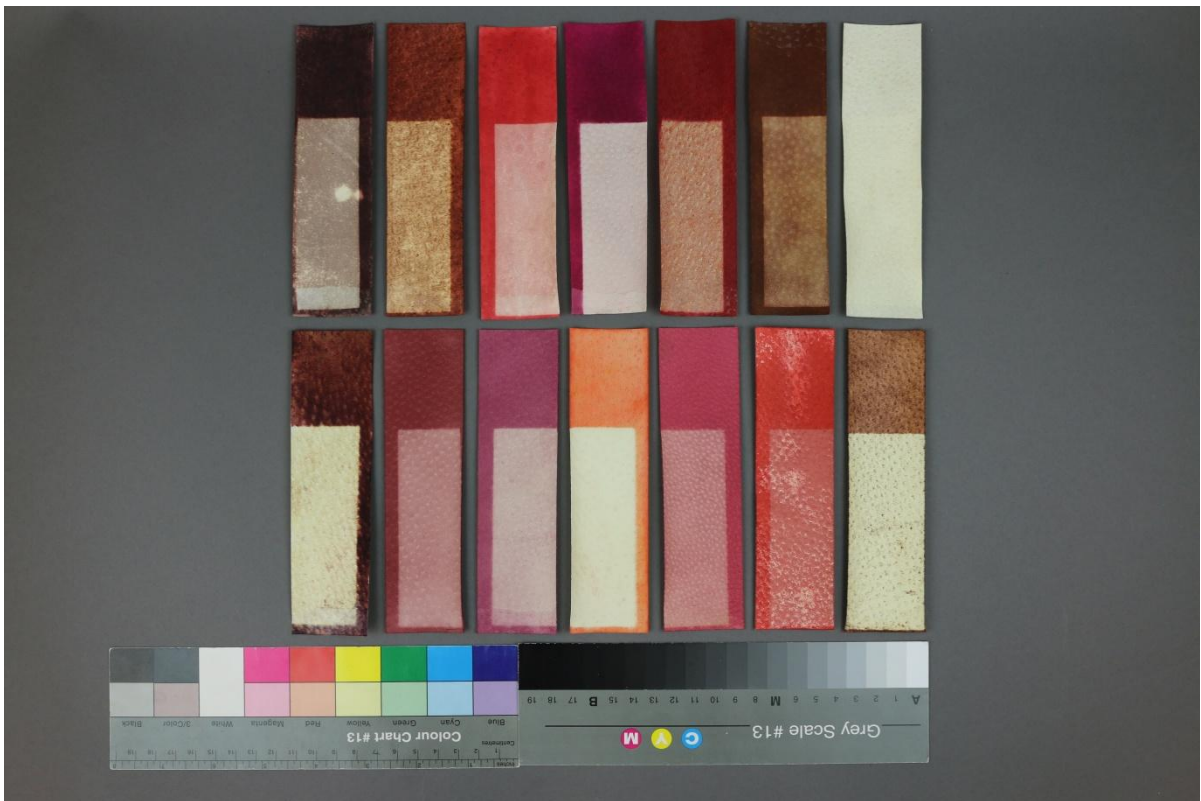
Obr. č. 17: Světelná stabilita červených odstínů barviv/ jircha – vzorky po stárnutí v QUV panelu
