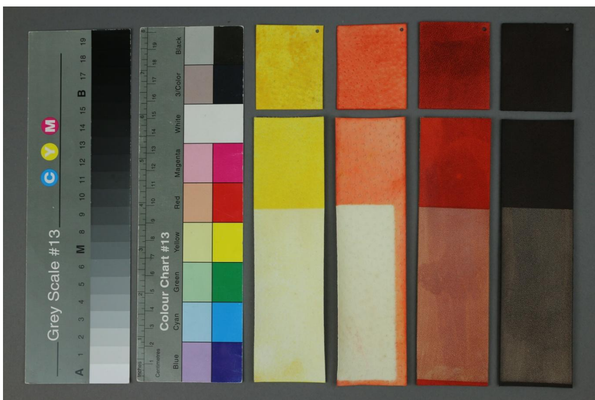
Obr. č. 41: J Hewit & Sons Ltd Leather Dye Powder, vzorky po stárnutí v QUV panelu
