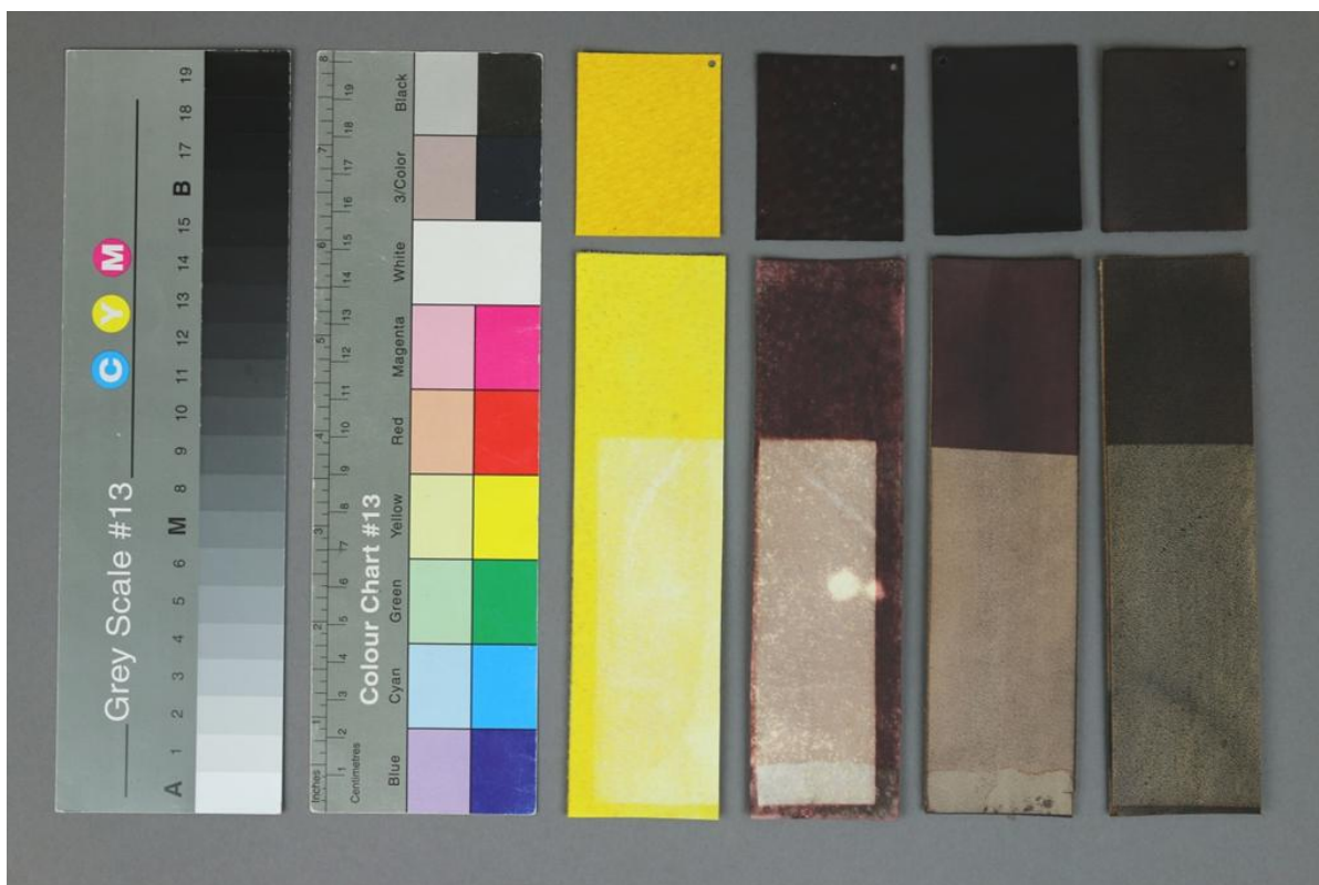
Obr. č. 23: Eco-Flo Leather Dye, vzorky po stárnutí v QUV panelu
