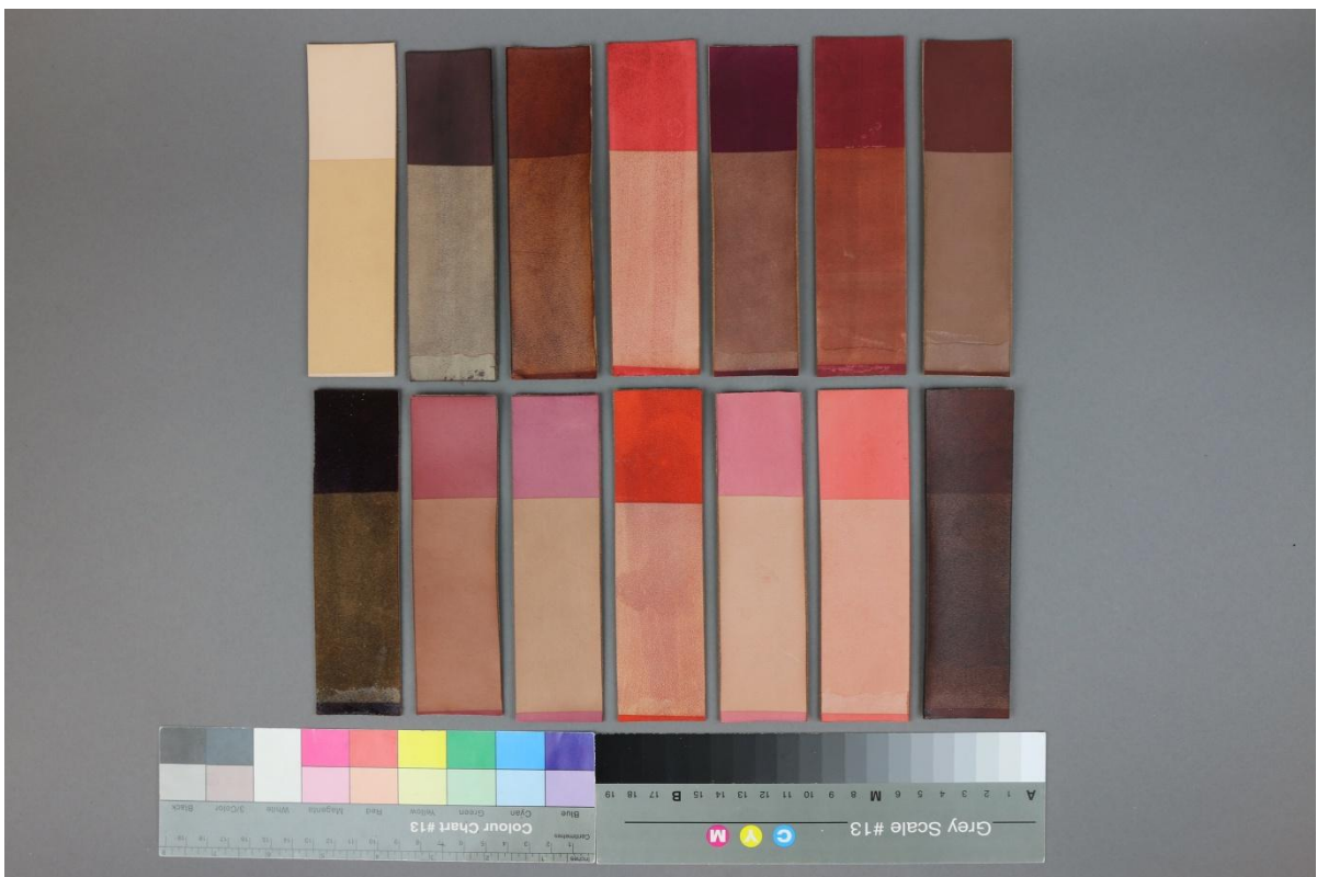
Obr. č. 19: Stálobarevnost červených odstínů barviv/ tříslučiněná useň – vzorky po stárnutí v QUV panelu
