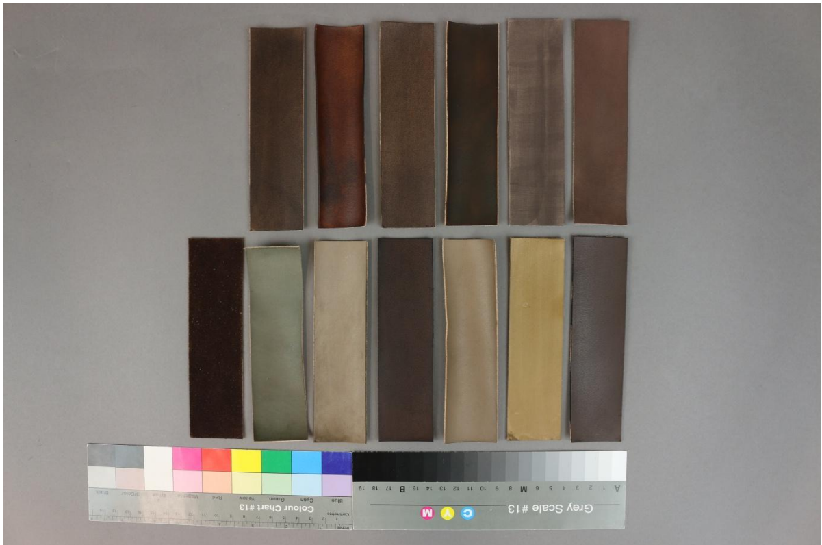
Obr. č. 20: Stálobarevnost hnědých odstínů barviv/ tříslučiněná useň – před stárnutím
