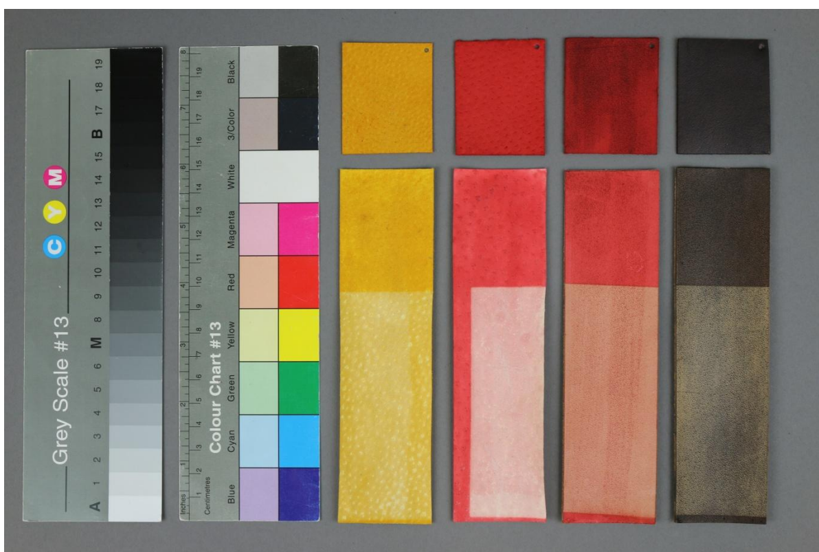
Obr. č. 27: Fiebing's Institutional Leather Dye, vzorky po stárnutí v QUV panelu
