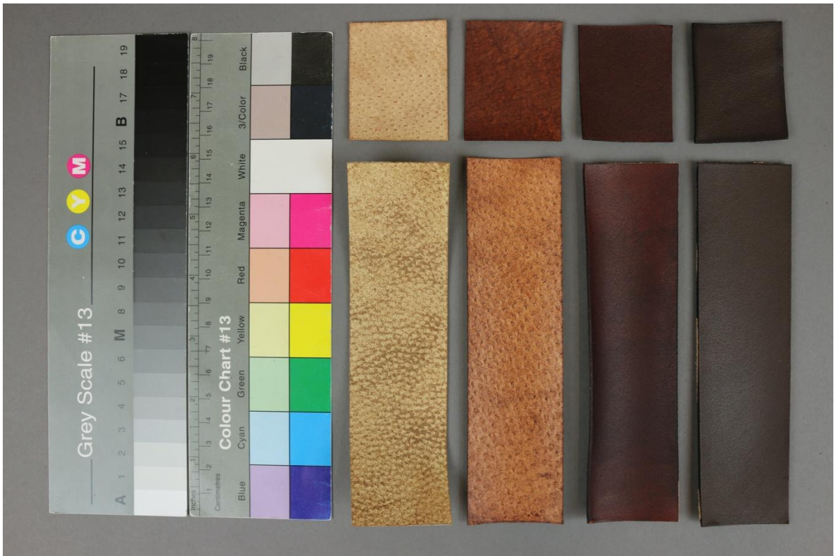
Obr. č. 46: The Identity Store Water Based Leather Stain, vzorky před stárnutím
