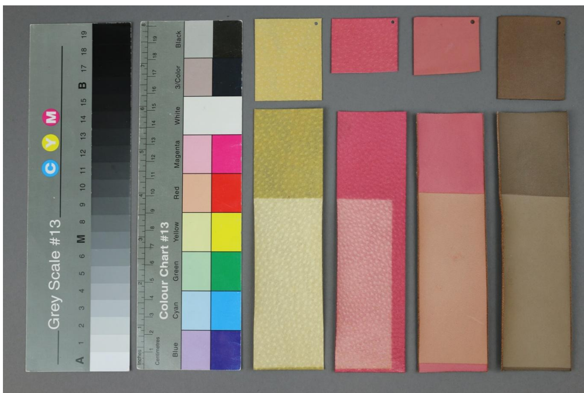
Obr. č. 43: Lihové mořidlo Druchema, vzorky po stárnutí v QUV panelu
