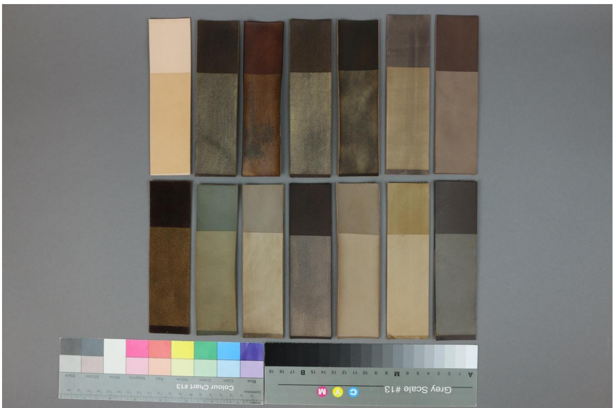
Obr. č. 21: Stálobarevnost hnědých odstínů barviv/ tříslučiněná useň – vzorky po stárnutí v QUV panelu
