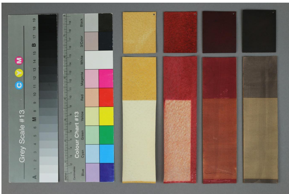
Obr. č. 31: Fiebing's Leather Stain, vzorky po stárnutí v QUV panelu
