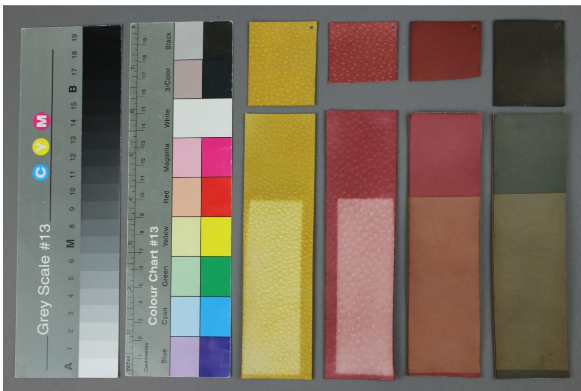
Obr. č. 37: Lihové mořidlo Chemoxyl, vzorky po stárnutí v QUV panelu
