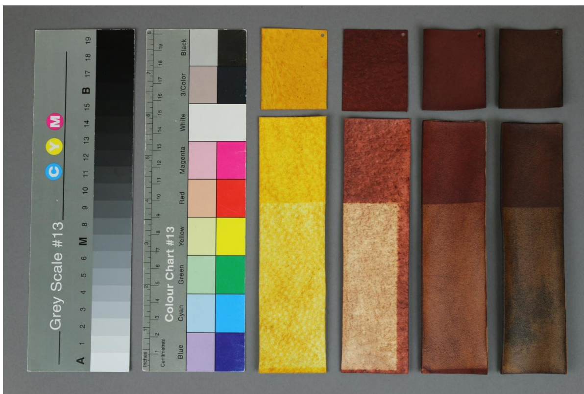
Obr. č. 25: Eco-Flo Professional Waterstain, vzorky po stárnutí v QUV panelu
