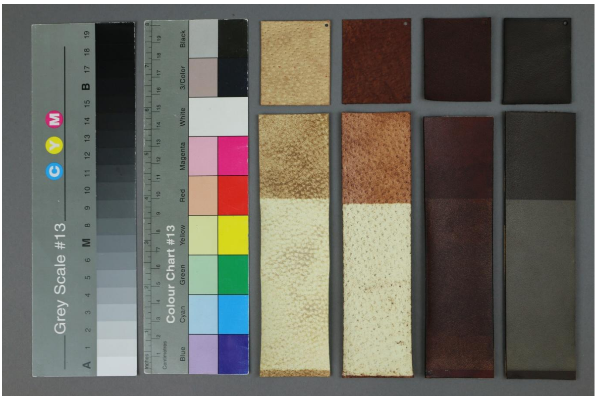
Obr. č. 47: The Identity Store Water Based Leather Stain, vzorky po stárnutí v QUV panelu
