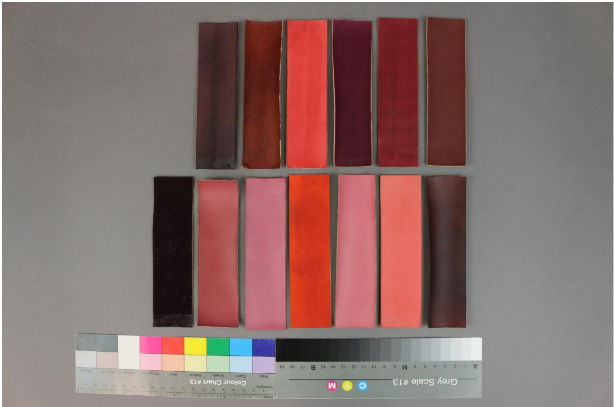
Obr. č. 18: Stálobarevnost červených odstínů barviv/ tříslučiněná useň – před stárnutím
