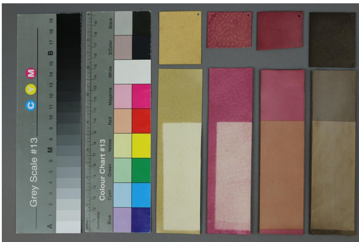
Obr. č. 39: Barva na kůži a semiš s domácí ovacím účinkem, po stárnutí v QUV panelu
