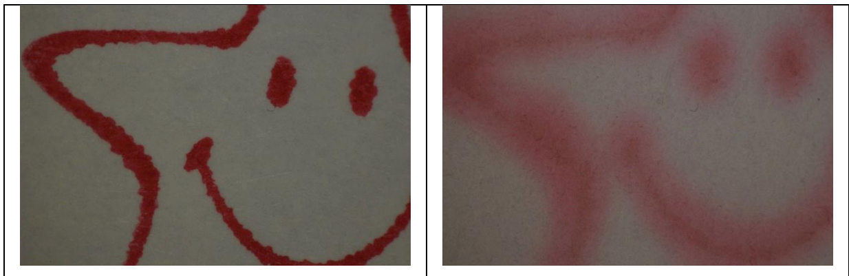
Obrázek 10 - Ruční papír – srovnávací nefixované vzorky, oplachované v deionizované vodě
