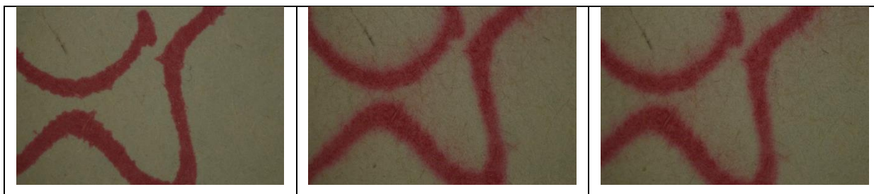
Obrázek 14 - Dřevitý papír – vzorky, fixované fixační kapalinou GSK, oplachované v deionizované vodě
