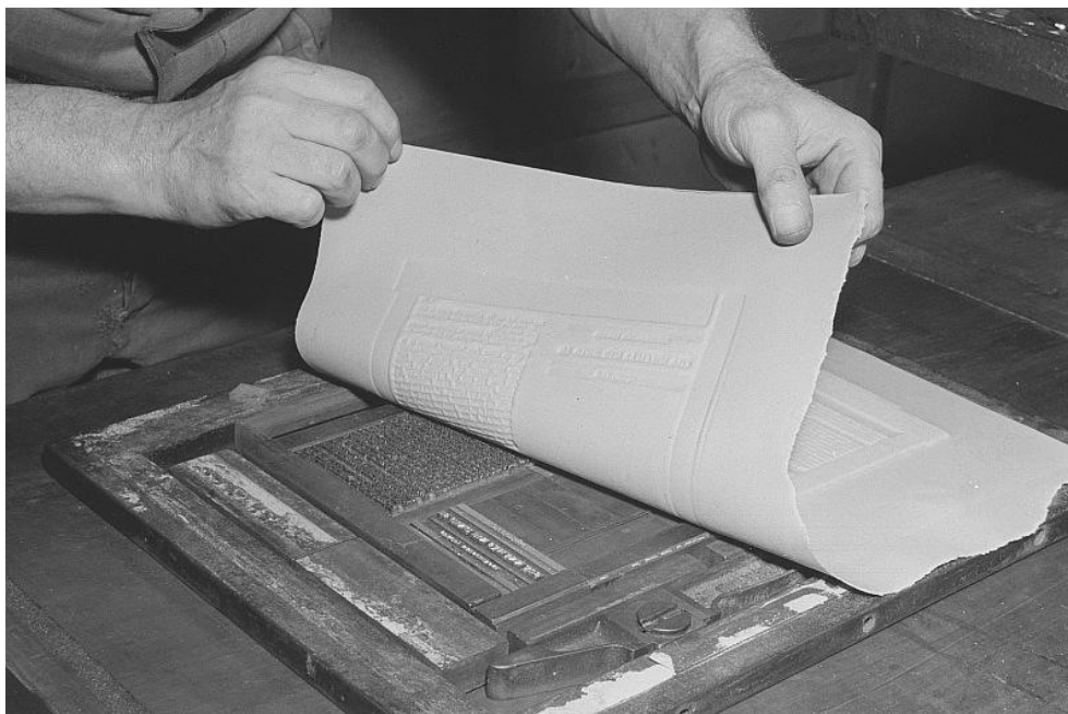
Obr. 15: Ukázka výroby matrice z papíru
