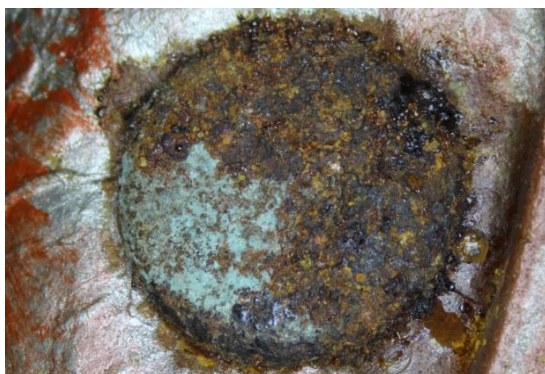
Obr. 135: Detail hlavičky hřebíku poškozeného korozí, foto pod stereomikroskopem
