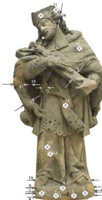
Obr. 2: Místa měření ultrazvukovou transmisí - čelní část plastiky. Foto a grafické zpracování: R. Tauchmanová.
