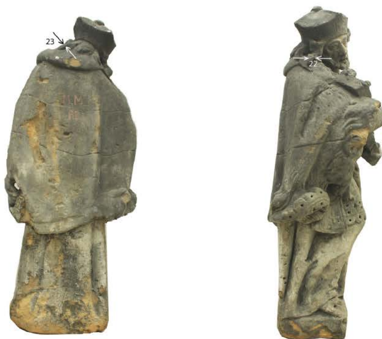
Obr. 3, 4: Místa měření ultrazvukovou transmisí - zadní a boční část plastiky. Foto a grafické zpracování: R. Tauchmanová.
