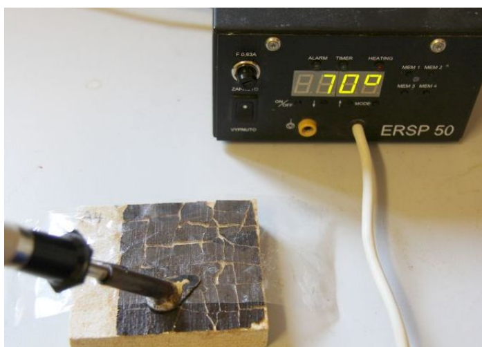
Obr. 8 Zažehlování umělých krakel přes melinexovou fólii tepelnou špachtlí s regulovaným ohřevem.
