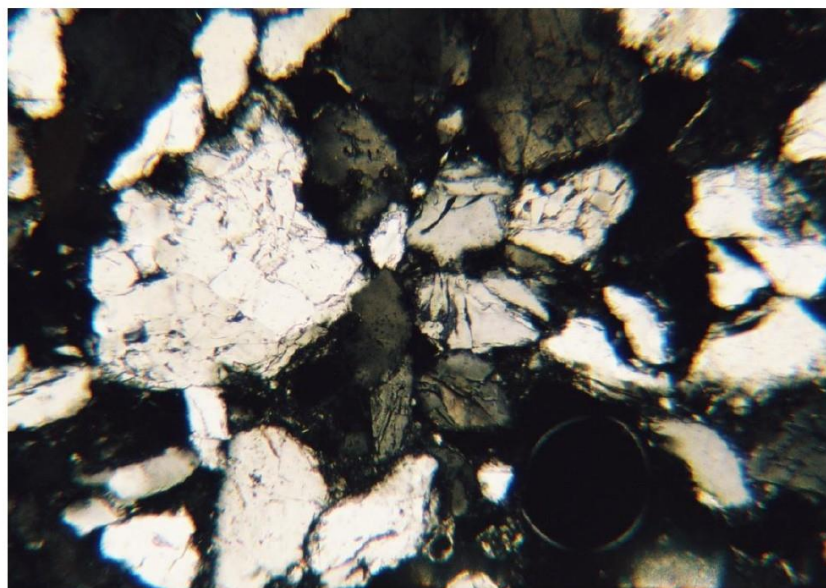
Pískovec křemenný, nerovnoměrně zrnitý, jemnozrnitý, slabě silicifikovaný vzorek KT-1, zvětšení 63 x, nikoly X mechanicky poškozené (drcené) úlomky křemene
