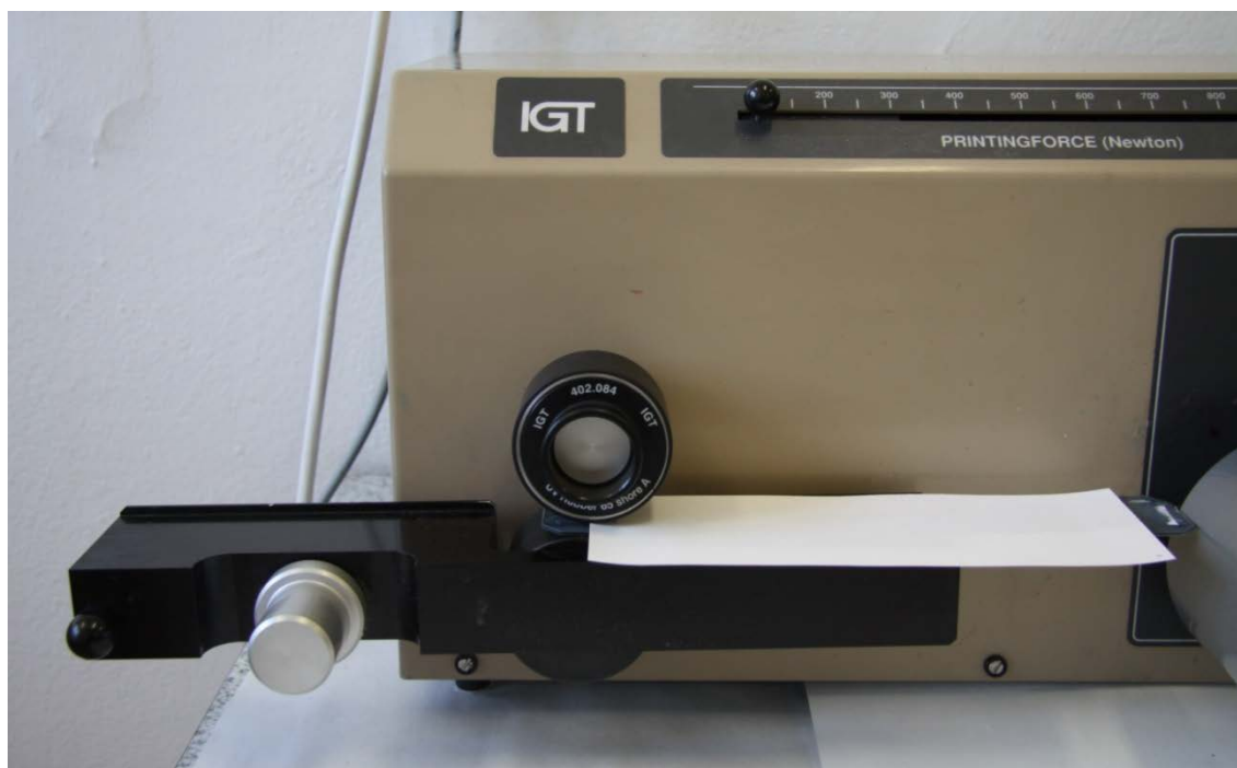
Obrázek 17 Potiskovací přístroj ITG C1, průběh testování účinnosti fixativ
