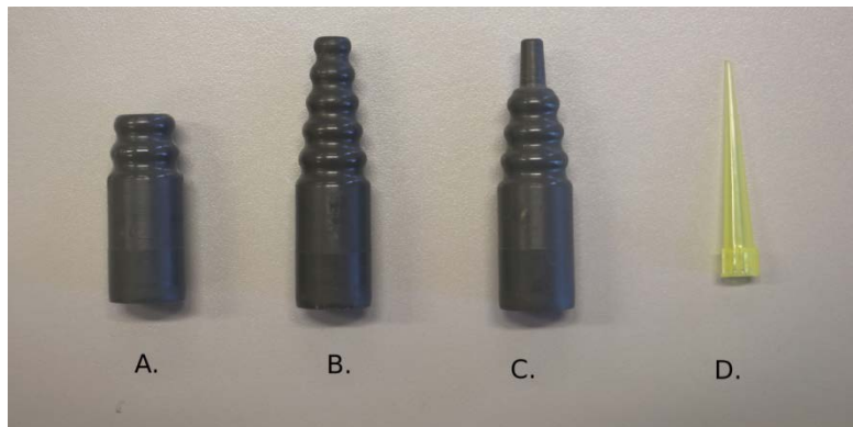
Obrázek 3 Měnitelné výstupní trysky s různými vnitřními průměry
