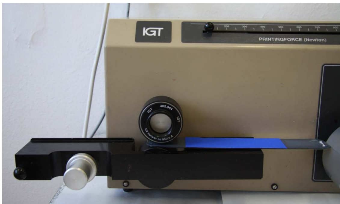
Obrázek 16 Potiskovací přístroj ITG C1, průběh testování účinnosti fixativ
