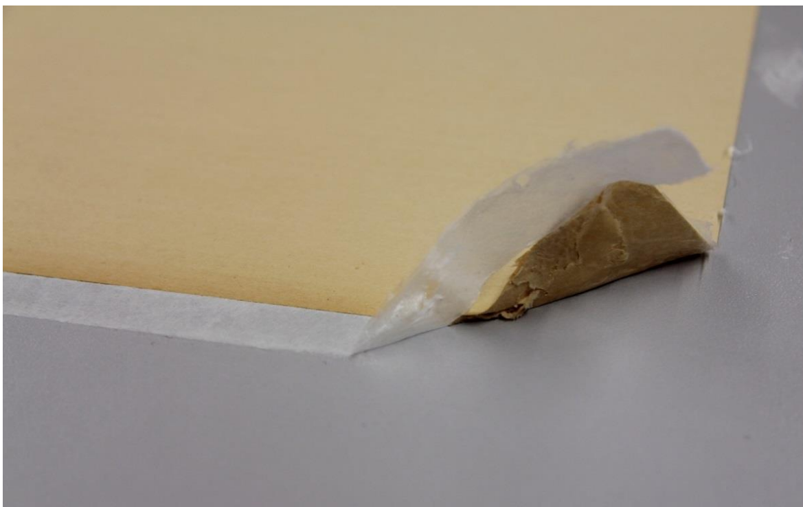
Obrázek 19. Detail štěpení a trhání papíru při pokusu o jeho sejmutí z tvrdé podložky.
