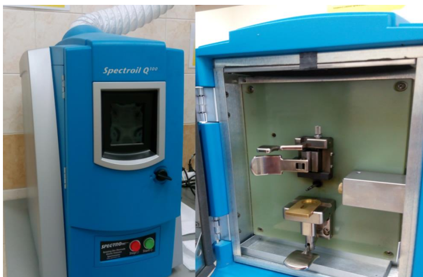
Obr. 18 Atomová emisní spektrometrie [vlastní]
