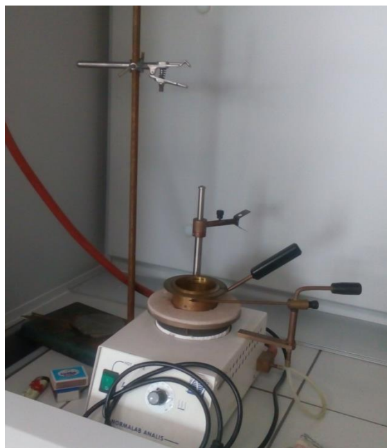
Obr. 13 Clevelandův otevřený kelímek [vlastní]
