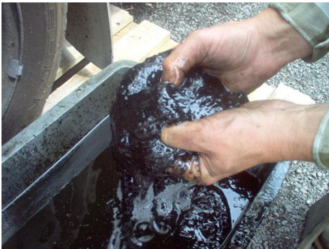
Obr. 5 Glykol v motorovém oleji [21]
