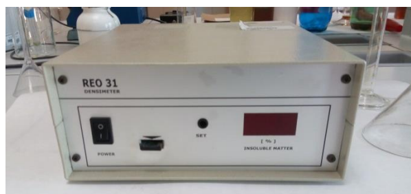
Obr. 14 Denzimetr REO 31 [vlastní]
