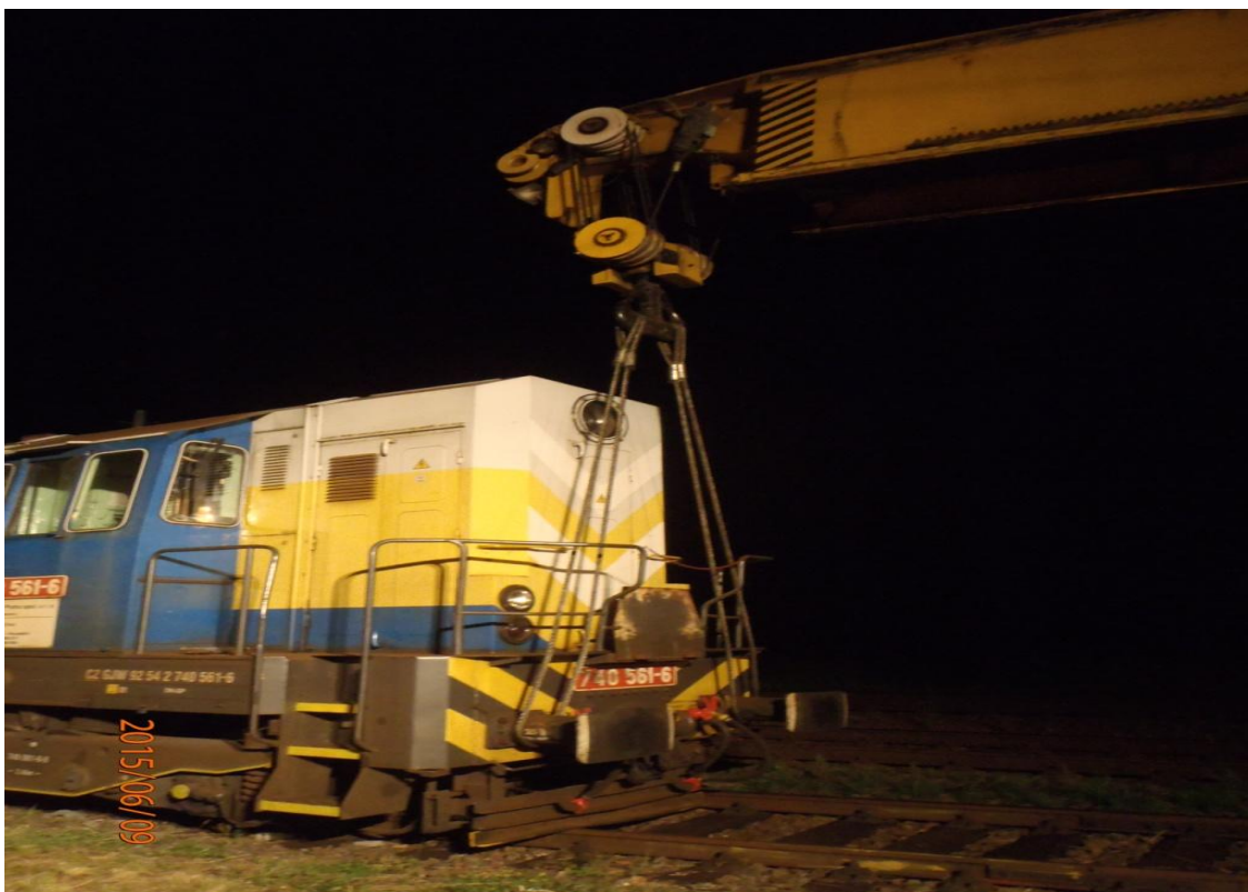
Obrázek č. 7: Nakolejování drážního vozidla
