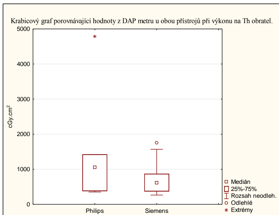
Obrázek 15 Graf porovnávající plošné kermy, naměřené u obou porovnávaných přístrojů pomocí DAP metru, při výkonu na Th obratel.
