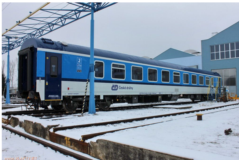
Obrázek 18: Nově zrekonstruovaný vůz řady Bdmpee 233 . Zdroj [21]
