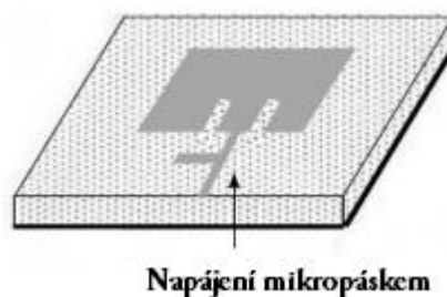
Obrázek 1.8 - Napájení pomocí mikropáskového vedení (6)
