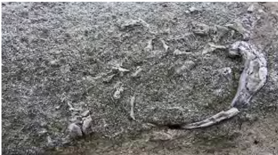
20) Povrch kutnohorského vápence. Vedle drobných úlomků schránek měkkýšů obsahuje kámen i větší části schránek, proto je odedávna kameníky označovaný jako „mušlák“.
