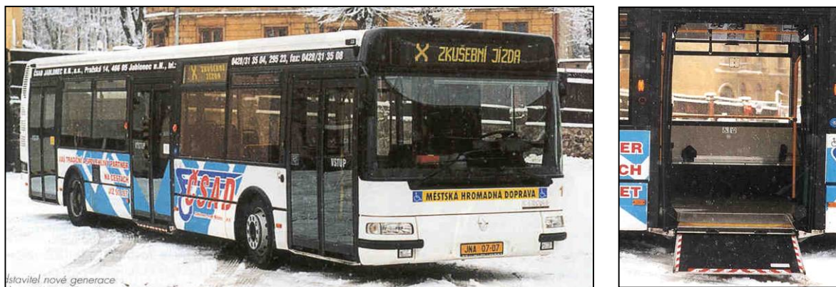
Obr. 4.6 Nízkopodlažní bezbariérový autobus Karosa-Renault City-bus z Karosy a. s.
