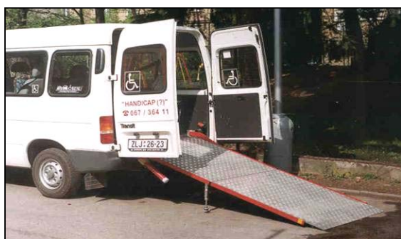
Obr. 4.10 Pohled na vozidlo Ford Transit vybavené nájezdovou rampou pro vozíčkáře humanitárního sdružení "HANDICAP(?)" Zlín
