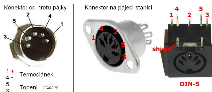
Obr. 3.1 – Zapojení konektoru pájecího pera (Janík, 2011 – 2016)
