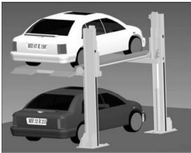
Obr. 19 Schématický nákres dvoupilířovitého parkovacího systému
