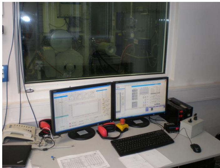
Obrázek 56 Ovládací systém ve velínu s výhledem na zkoušený motor
