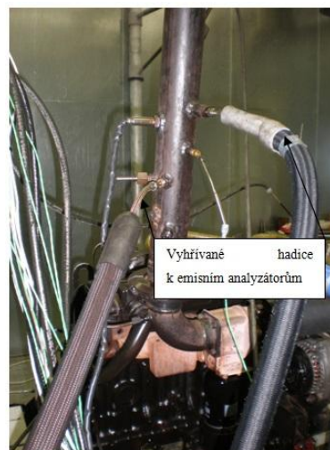
Obrázek 54 Vyhřívané hadice připojené k výfuku
