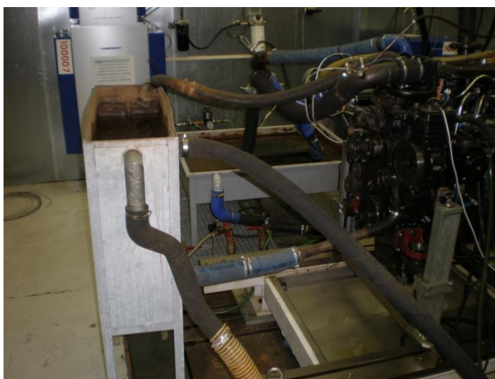
Obrázek 52 Připojená chladicí nádoba k motoru a vnějšímu okruhu
