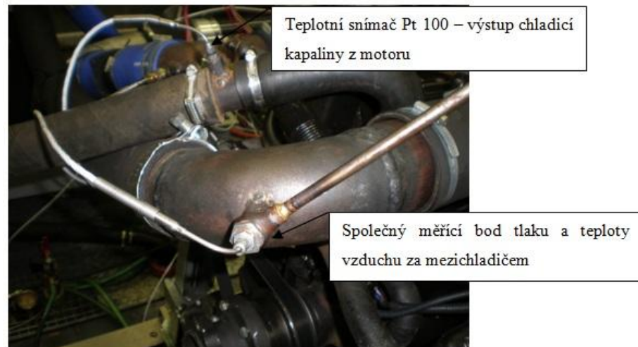
Obrázek 48 Příklad umístění snímačů na motoru MMZ D245.2S3B
