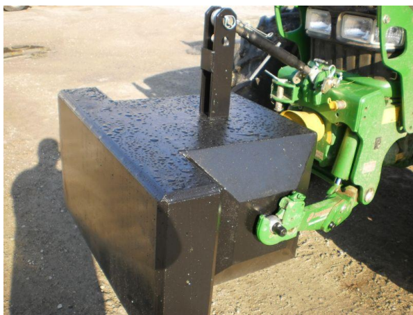
Obr. 16 – Balastní závaží na přední části traktoru 60
