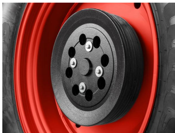
Obr. 17 – Balastní závaží na zadním kole traktoru 61
