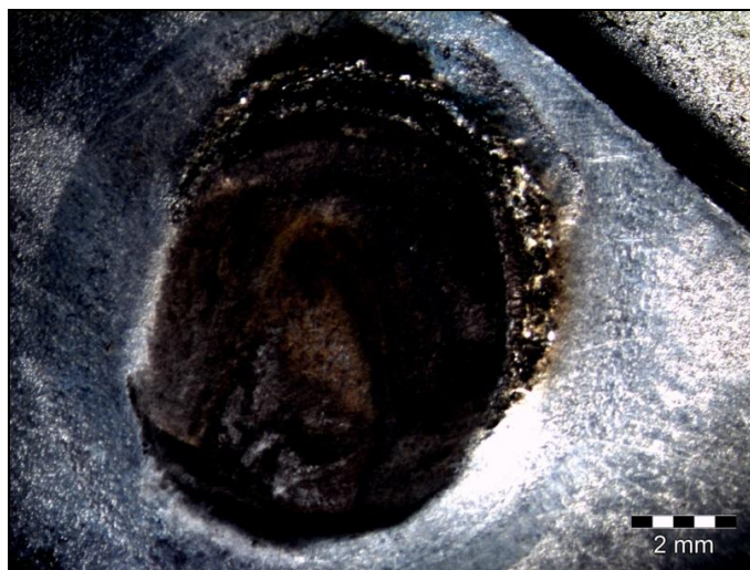
Obrázek 13: Bodový svar vzorku č. 2
