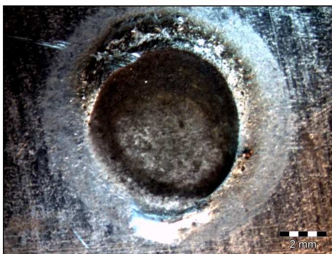
Obrázek 12: Bodový svar vzorku č. 1
