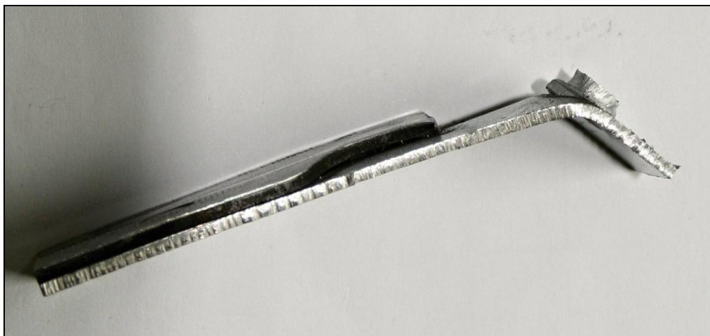
Obrázek 27: Vzorek č. 10 po provedení tahové zkoušky
