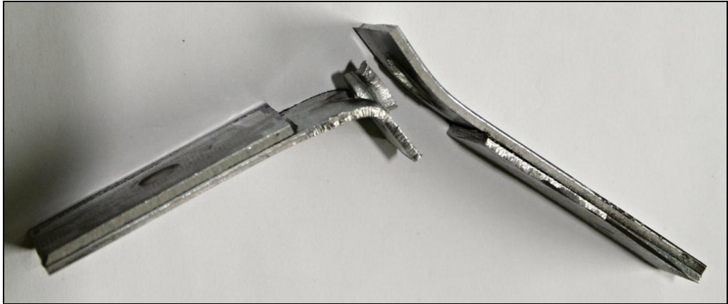
Obrázek 28: Vzorek č. 12 po provedení tahové zkoušky
