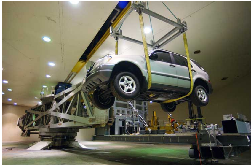
Obrázek 2.9: Zavěšení vozu na centrifugu, zdroj NASA [7]
