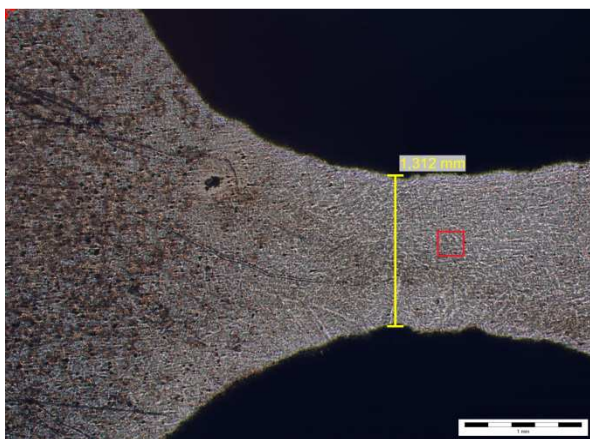
Obr. 44: Naznačení místa zvětšení, leptáno Nital, 25x
