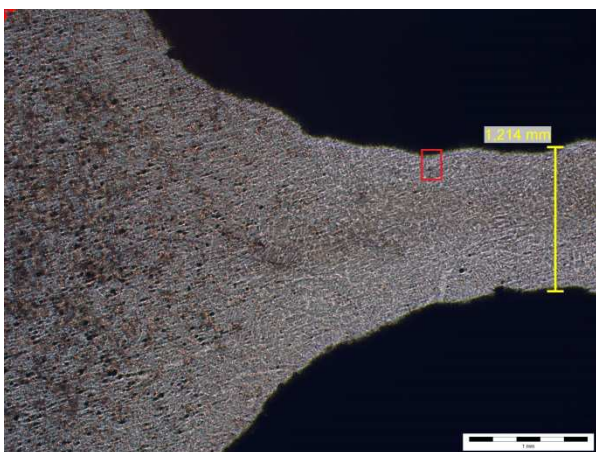
Obr. 38: Naznačení místa zvětšení, leptáno Nital, 25x
