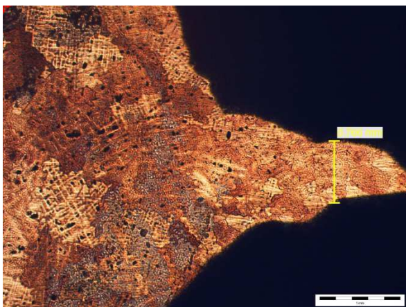
Obr. 31: Bronz, leptáno, 10% hydroxidem železa, 25x
