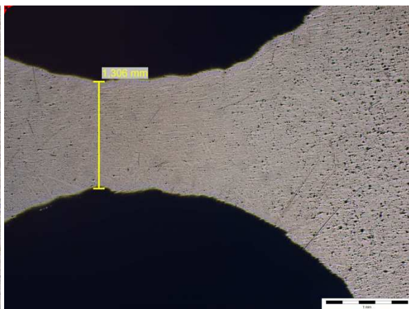
Obr. 36: Mikrostruktura litiny zvětšení 25x
