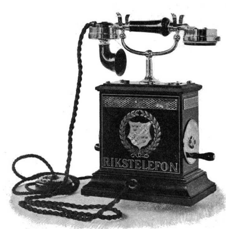
Obrázek 1 Švédský telefon pro manuální ústředny (1896) [2]
