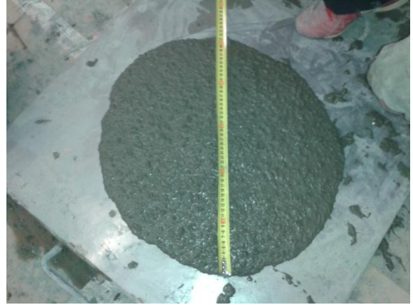
Obrázek 33 Zkouška sednutím 3. záměsi
