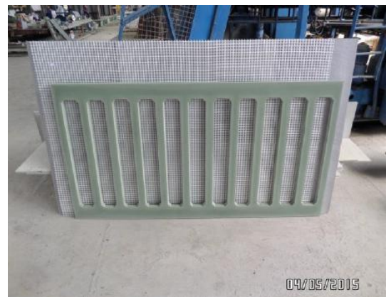
Obrázek 13 Zábradelní panel u UHPC [32]
