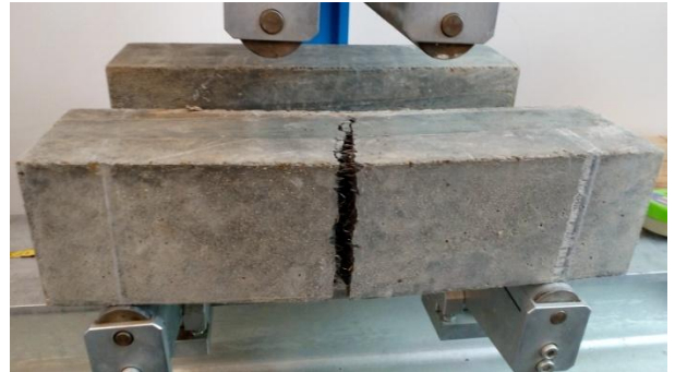
Obrázek 40 Porušení hranolu s drátkou
