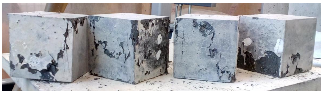
Obrázek 42 Porušení krychlí s drátky
