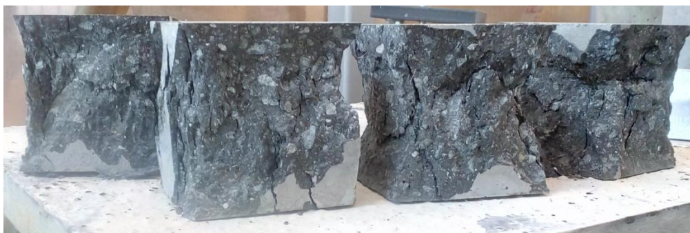
Obrázek 41 Porušení krychlí bez drátků
