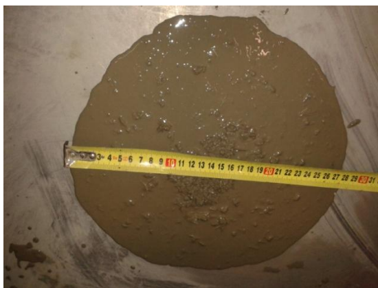
Obrázek 27 Rozlití Haegermannova kužele záměsí 3.3
