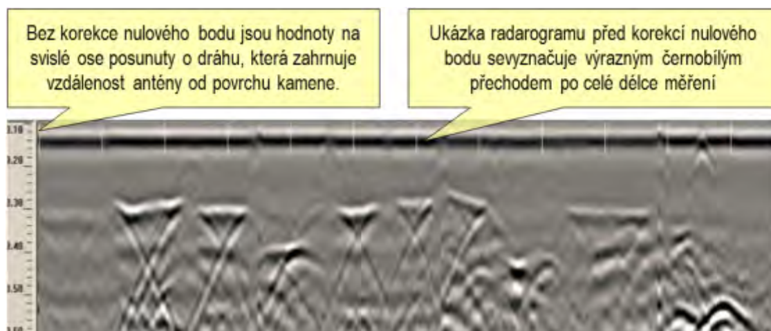
Obrázek 24: Ukázka neupraveného radarogramu bez dodatečných SW úprav
