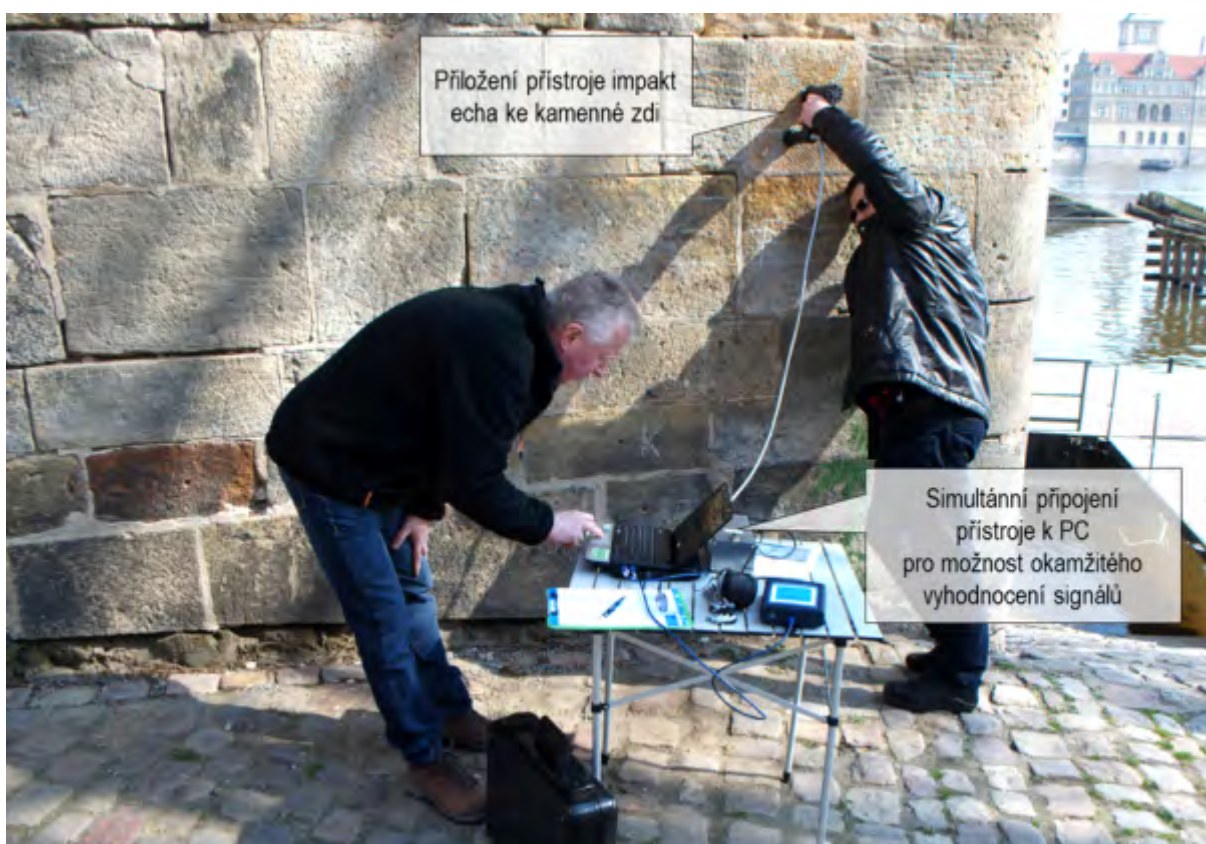
Obrázek 12: Ukázka měření v terénu při simultánním připojení s PC.
