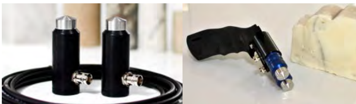
Obrázek 18: Širokopásmové sondy (vysílač a přijímač) s konickým zakončením - vlevo, komerčně vyráběné zařízení pro uchycení měřících sond pro povrchové ultrazvukové měření - vpravo
