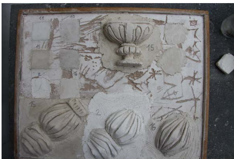
Obr. 6 Zkoušky aplikace a modelace - testování tvárných směsí. Foto: Jana Waisserová.
