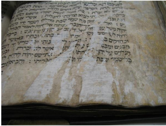
Obr. 112 Smrštění pergamentu, sig. 67.601
