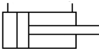
Obr. 1.12 – Schématická značka jednočinného hydraulického válce
