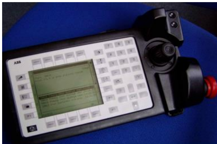
Obr. 1.23 – Přímé programování - ruční zadávání (přenosný operátorský panel)
