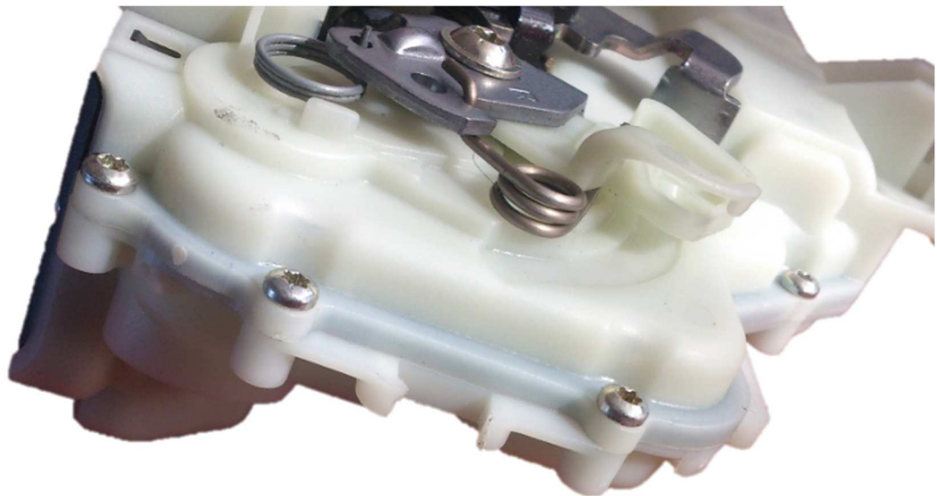
Obrázek 5 - Příklad šroubového spojení samořeznými šrouby (6)
