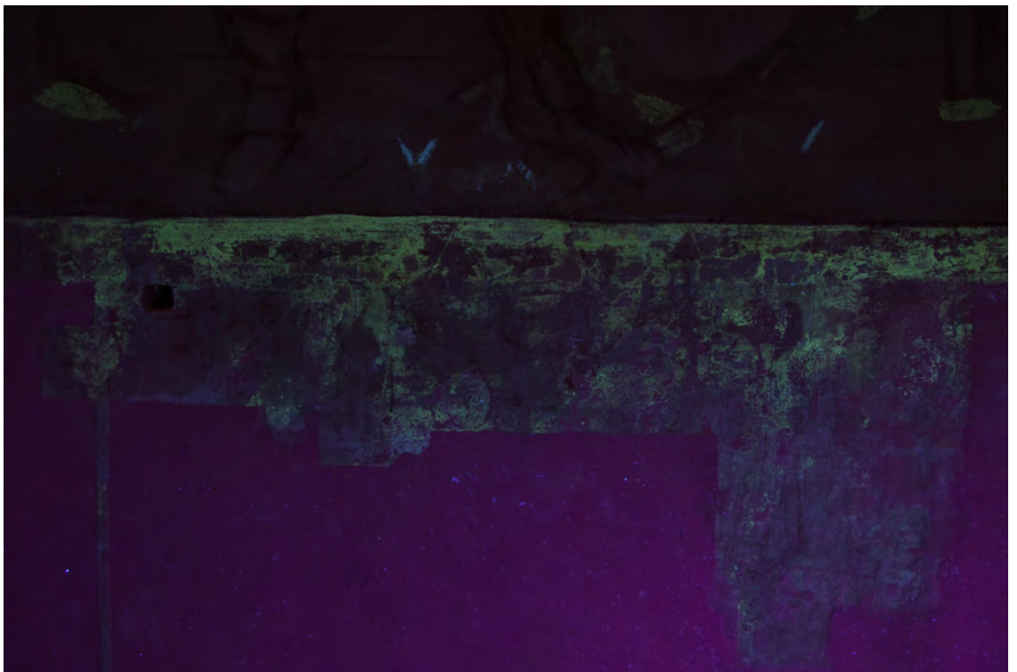
Obr. 23: Sonda 1SV 13 v odraženém UV světle; luminují fragmenty okrového nátěru, v němž byla pravděpodobně použita zinková běloba
