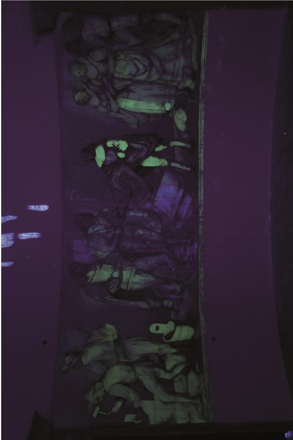
Obr. č. 32: Výjev ze stavby zámku Humprecht s postavami Humprechta Jana Černína a Carla Luraga, v UV světle. Zde je patrná žlutozelená luminiscence běloby, hlavně v oblasti figur. (Zdroj: Univerzita Pardubice, archiv Fakulty restaurování, Jiráskova 3, 570 01 Litomyšl )
