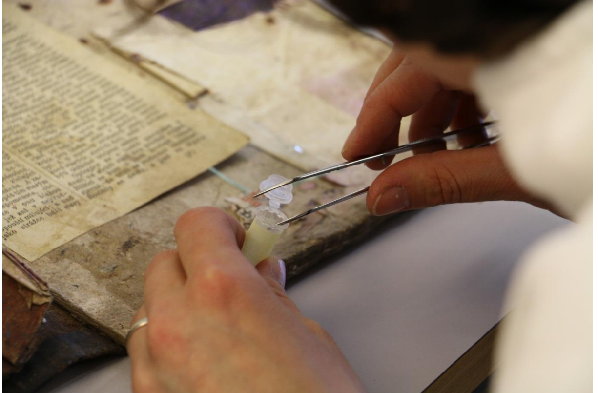
Obrázok 25 Odoberanie vzorkov pre chemicko-technologické analýzy
