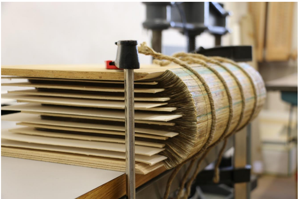
Obrázok 48 Zagul'tený knižný blok pod záťažou
