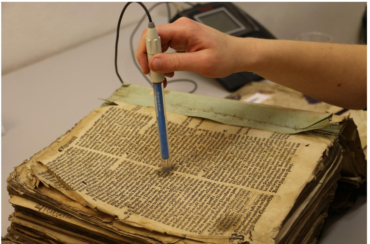
Obrázok 26 Meranie pH papiera dotykovou elektródou pred reštaurátorským zásahom
