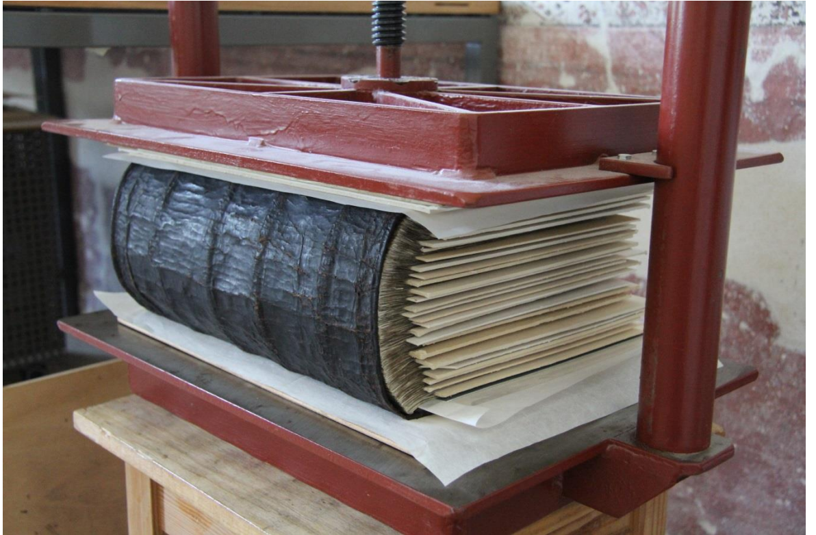
Obrázok 59 Zalisovaná kniha počas sušenia lepených spojov
