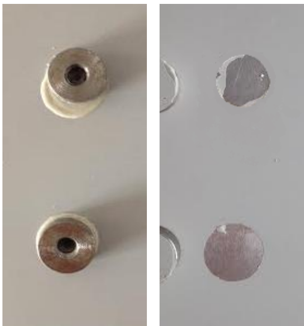
Obr. 24: Odrhová zkouška nátěru Eternal na kovy na ocelovém panelu, nalevo po nalepení terčíku, napravo odtržené terčíky
