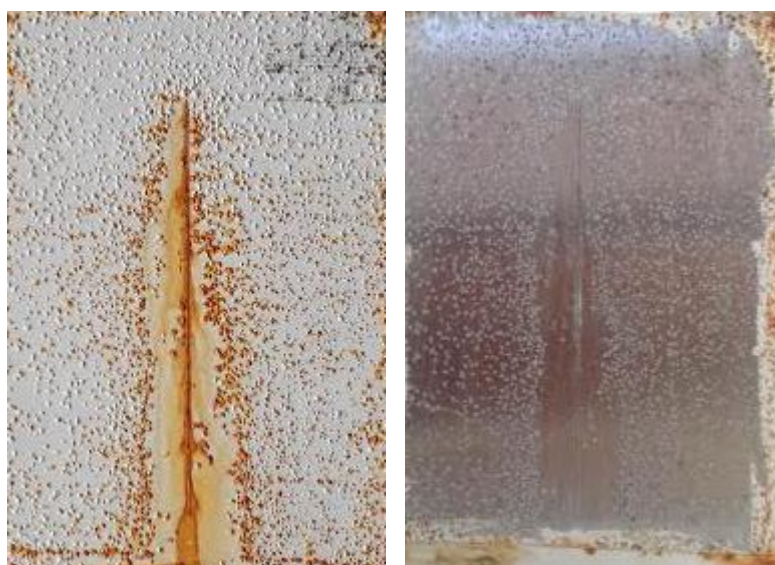
Obr. 21: Nátěr Eternal na kovy podrobený korozní zkoušce v mlze NaOH, nalevo po 96 hodinách v solné komoře, napravo po stažení nátěru
