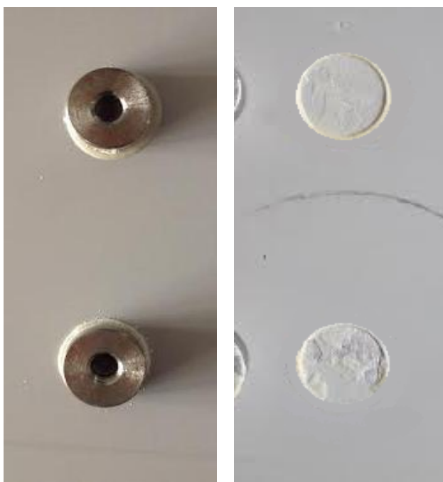
Obr. 25: Odrhová zkouška nátěru Eternal na kovy na hliníkovém panelu, nalevo po nalepení terčíku, napravo odtržené terčíky
