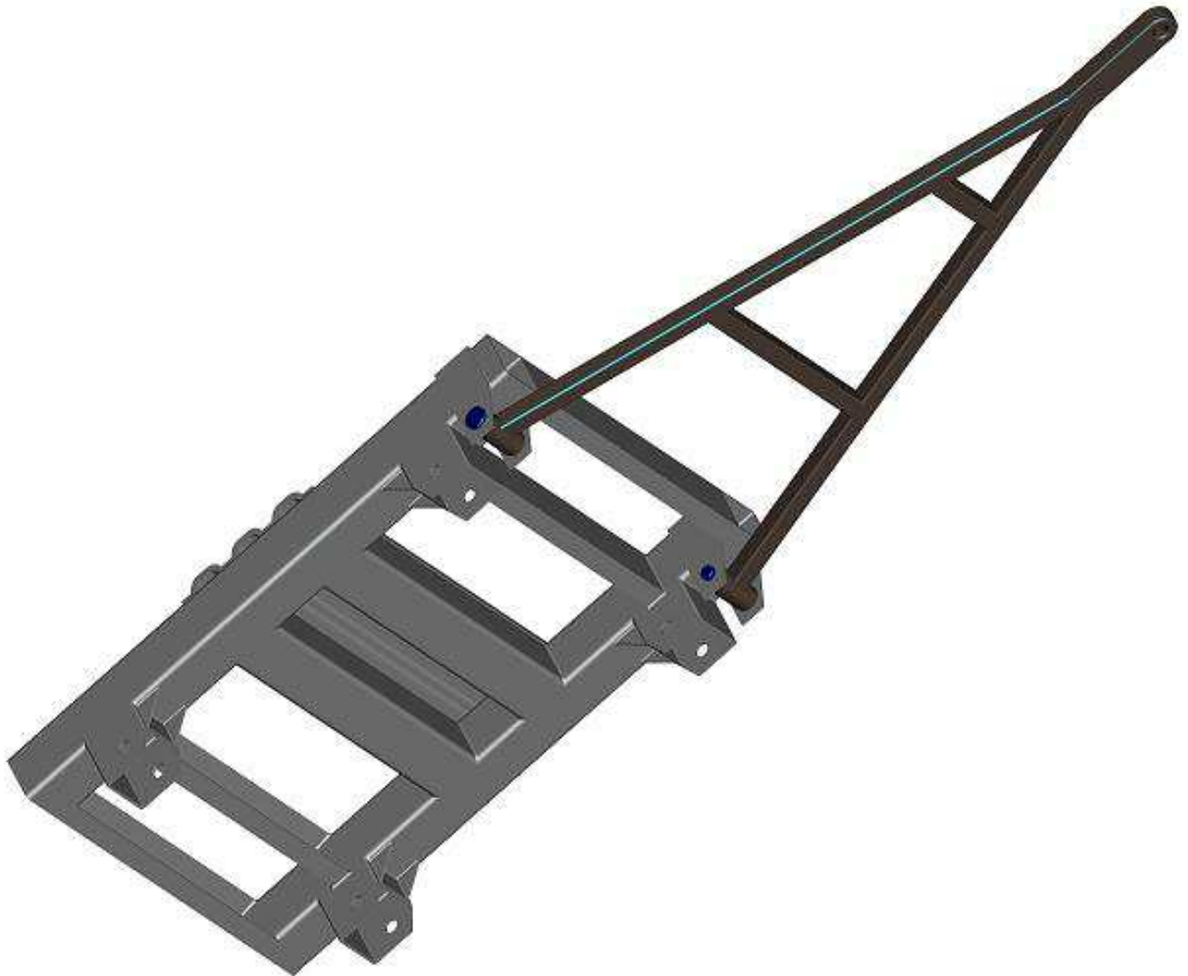
Obr 6. Pohled na rám ze spodní strany
