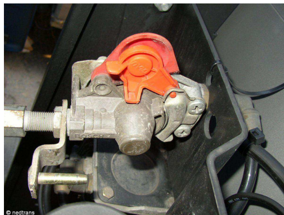
Obr 27. Detail zapojení žlutého a červeného vzduchového kohoutu [17]
