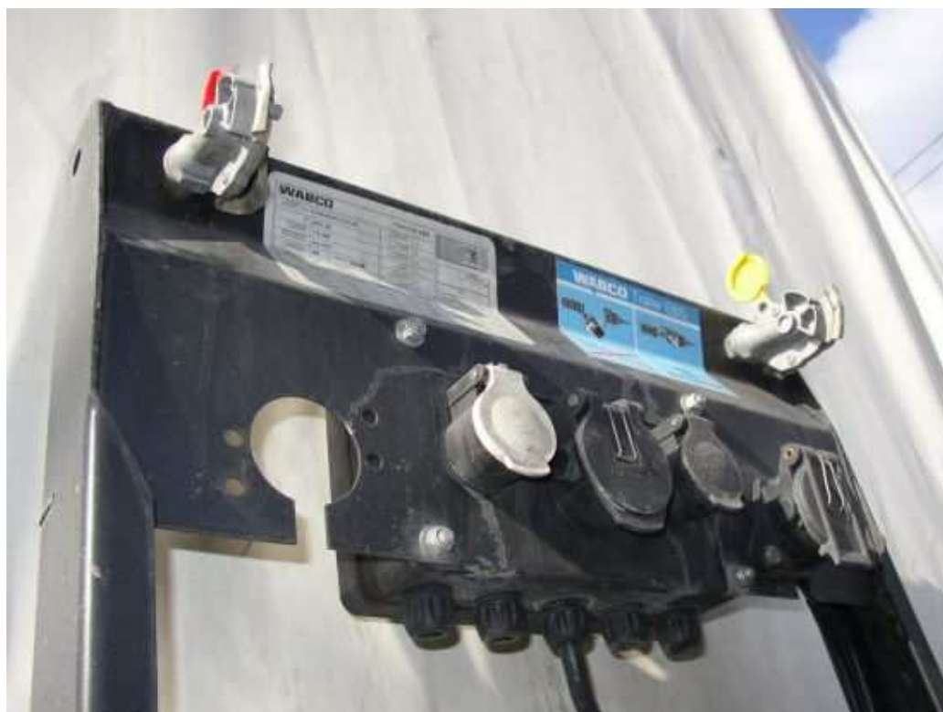
Obr 38. Detail zásuvek pro připojení elektroinstalace na automobilovém návěsu [17]
