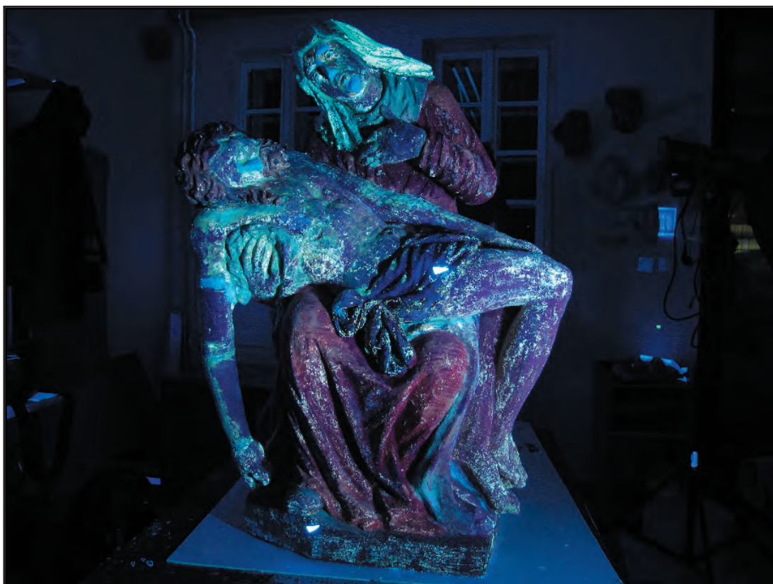
Obr. 34 Ozáření ultrafialovou analyzační lampou UVASPOT 400/T žřejmé jsou zejména novodobé doplňky.
