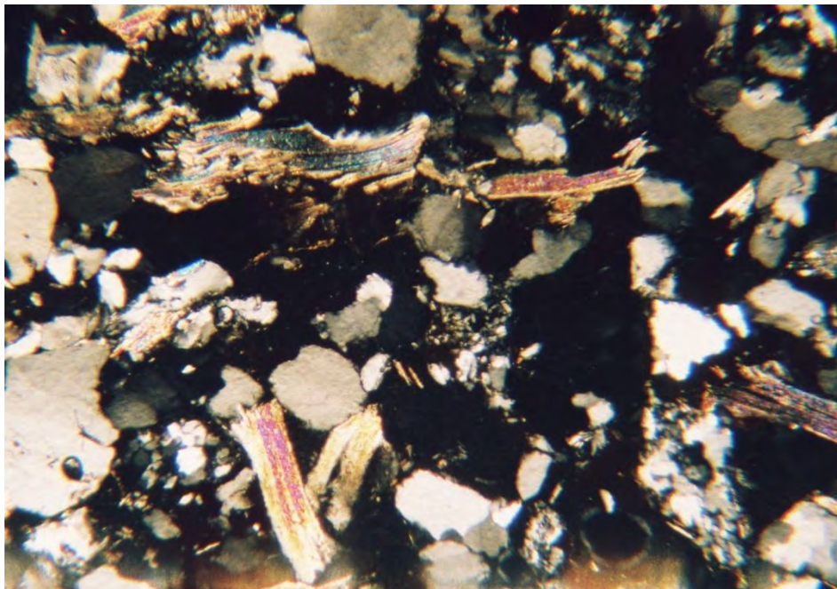
Pískovec křemenný, středně zrnitý, slabě silicifikovaný, hematitizovaný vzorek PS-1, Pieta-ložná plocha, zvětšení 32x, nikoly X intenzivní degradace slídové klastiky a matrix pronikem minerálů Fe (hematit, limonit)
