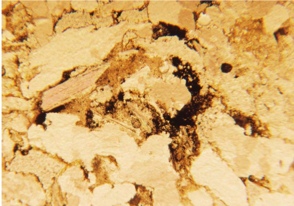
Pískovec křemenný, středně zrnitý, slabě silicifikovaný, hematitizovaný vzorek PS-1, Pieta-ložná plocha, zvětšení 32x, nikoly II hematitizace základní hmoty v interklastickém prostoru (na snímku černá)
