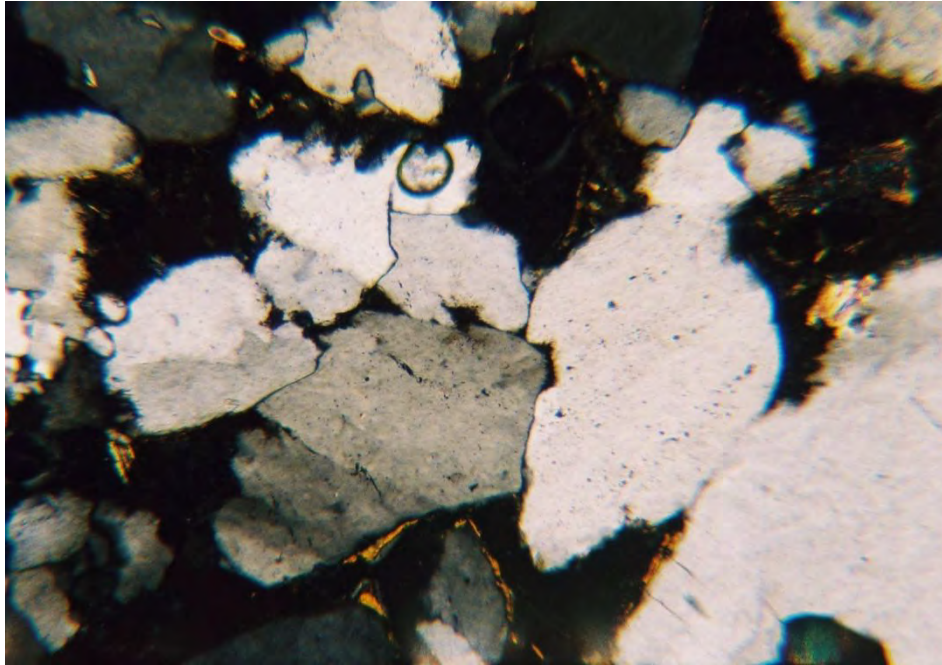
Pískovec křemenný, středně zrnitý, slabě silicifikovaný, hematitizovaný vzorek PS-1, Pieta-ložná plocha, zvětšení 63x, nikoly X projevy silicifikace struktury – srůsty křemenných klastů, hematitizovaná matrix v IKP
