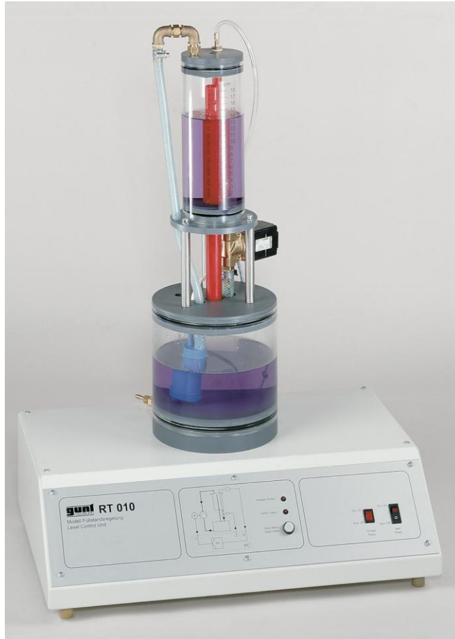
Obr. 6.1 - Reálná hydraulická soustava Gunt RT010 (G.U.N.T Hamburg 2005)
