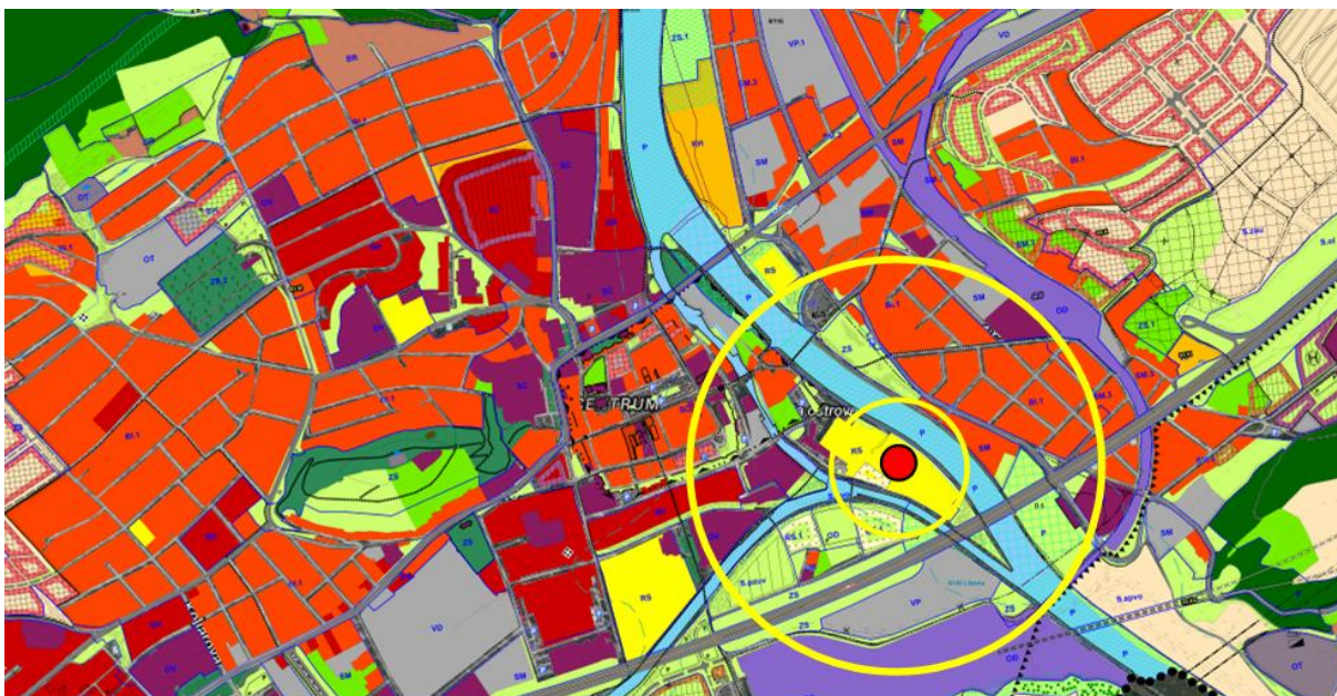
Obr. 61: Výřez územního plánu města Beroun – Hloubka smrtelného nebo zraňujícího zamoření při úniku chlóru 3
