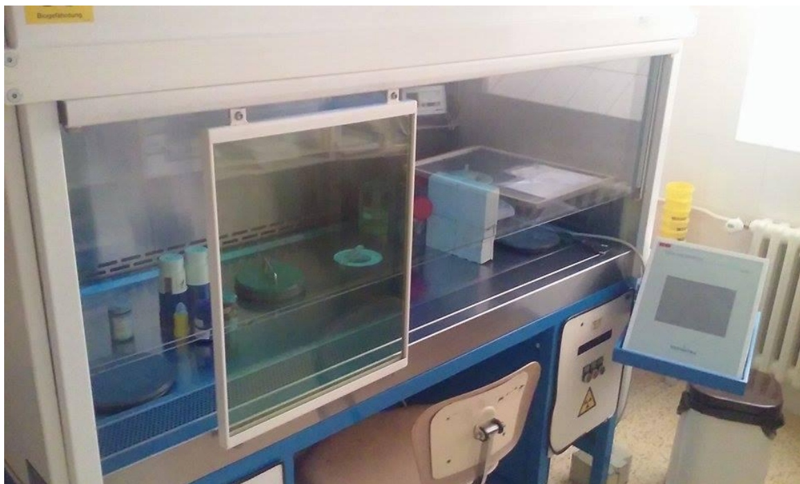
Obrázek 14 Digestoř pro přípravu radiofarmaka
