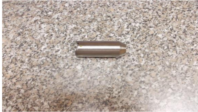
Obrázek 7 Wolframový kryt stříkačky (vlastní zdroj)
