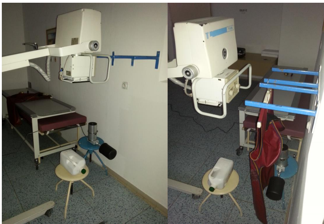
Obr. č. 5: RTG a detektor záření se zástěrou a bez zástěry
