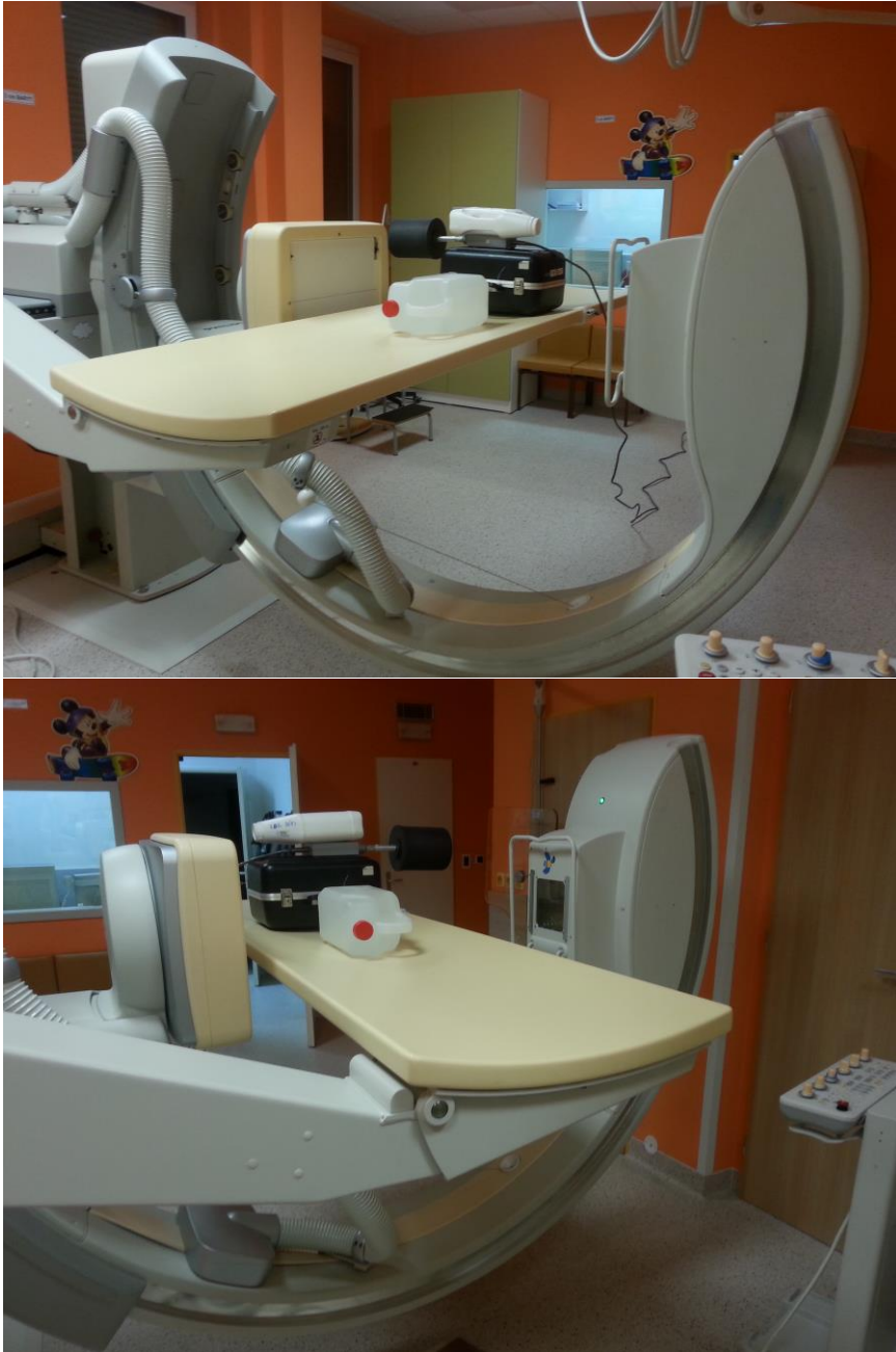
Obr. č. 10: Nastavení měřiče záření u rentgenky nebo u detektoru
