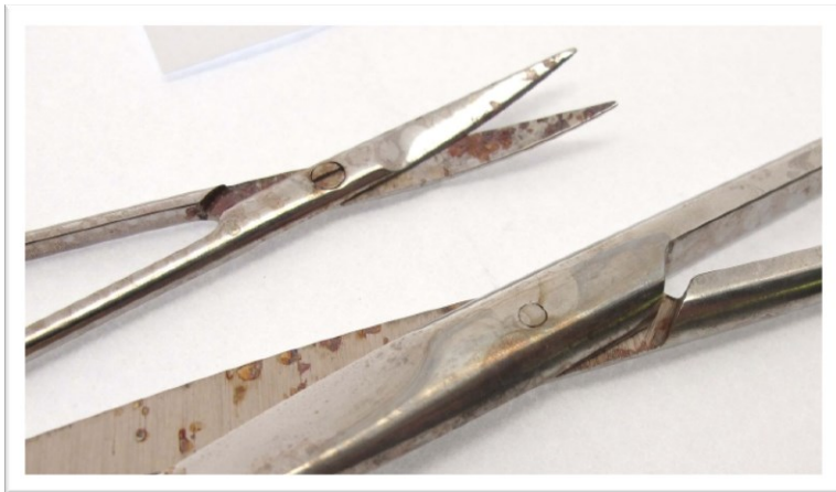
Obrázek 11 Vznik elektrolytického článku (archiv MEDIN, a.s.)
