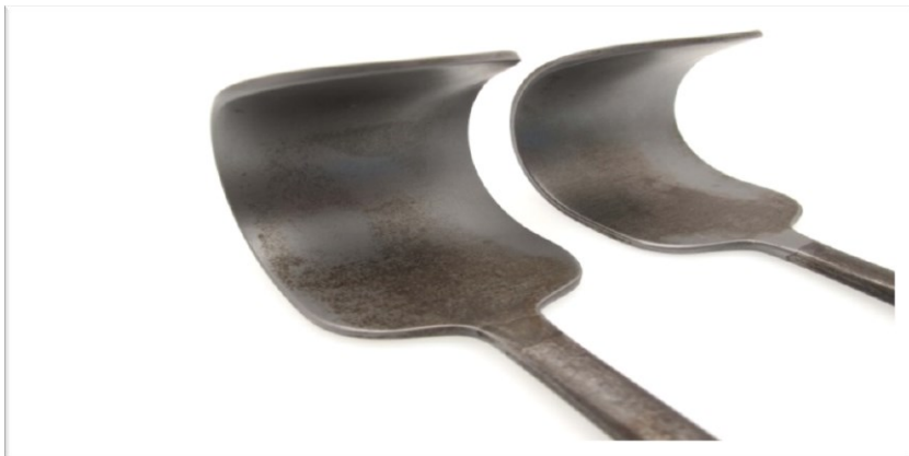
Obrázek 7 Detail nástrojů při použití vadné roušky (archiv MEDIN, a.s.)
