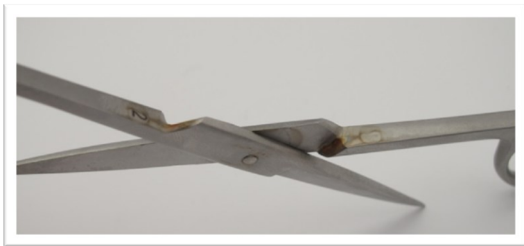
Obrázek 9 Koroze způsobená třením (archiv MEDIN, a.s.)
