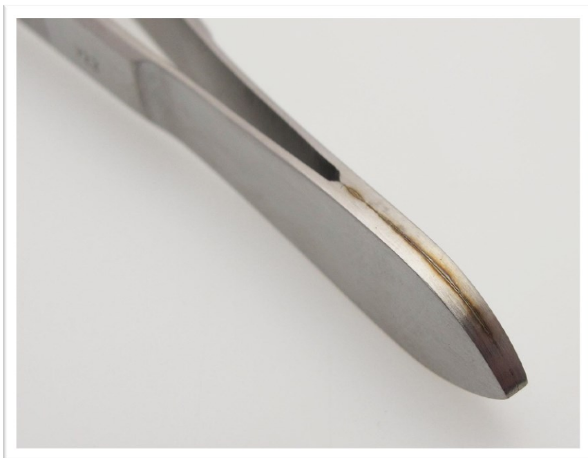
Obrázek 10 Spárová koroze (archiv MEDIN, a.s.)
