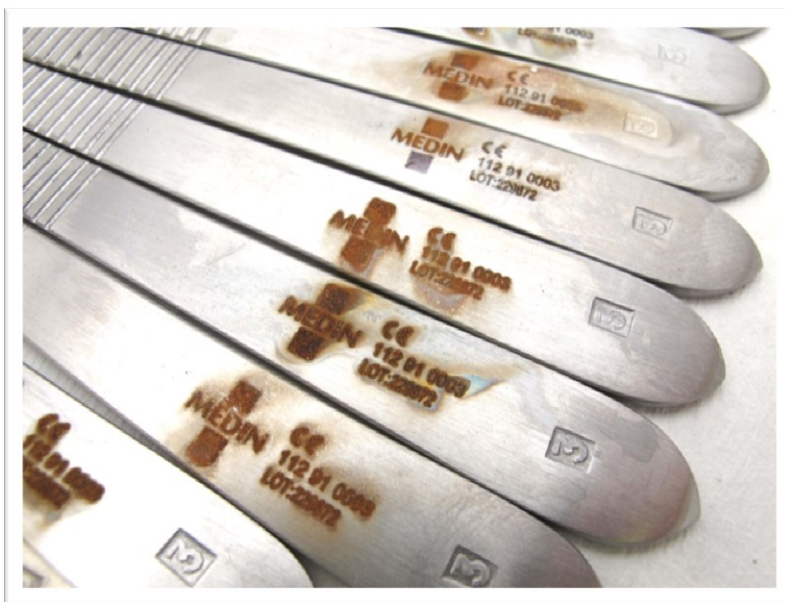
Obrázek 5 Poškození nástrojů agresivním mycím prostředkem a skladováním ve vlhkém prostředí (archiv MEDIN, a.s.)
