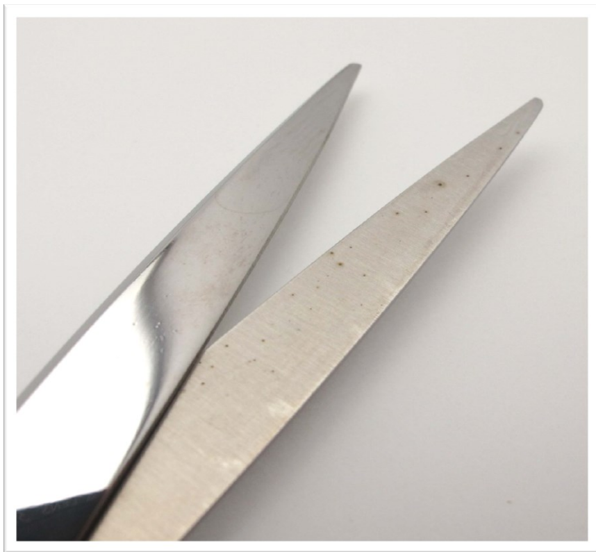
Obrázek 8 Bodová koroze (archiv MEDIN, a.s.)
