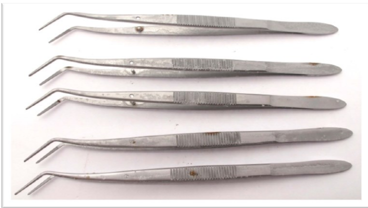
Obrázek 2 Poškození nástrojů při použití agresivního dezinfekčního prostředku (archiv MEDIN, a.s.)
