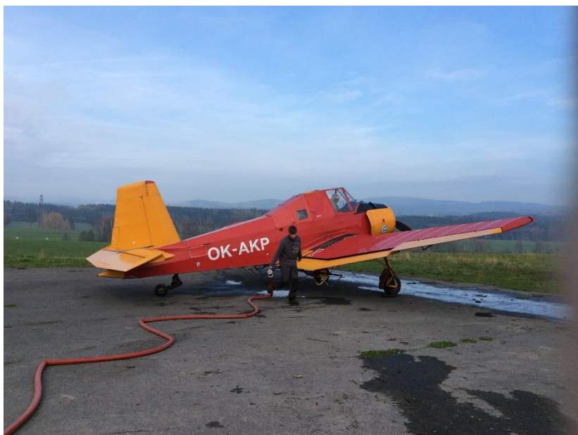
Obrázek 10 - Plnění letadla Z-37 kapalnými látkami 3
