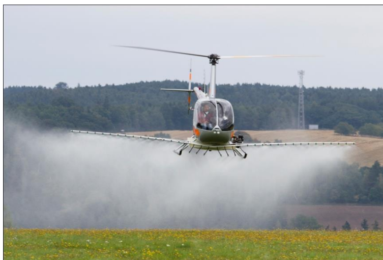
Obrázek 4 - Vrtulník Robinson R44 při aplikaci postřiku (autor)
