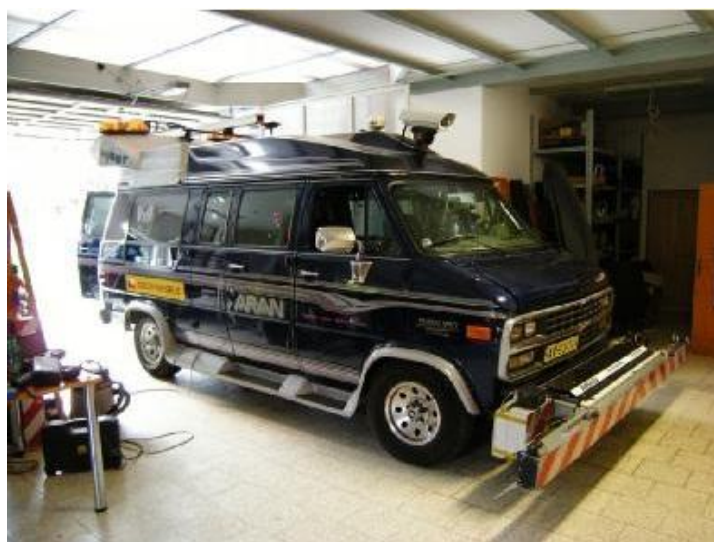
Obrázek 25: Dodávkový vůz firmy VARS BRNO a. s. značky Chevrolet s nástavbou ARAN [15]
