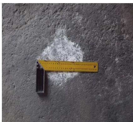
Obrázek 15: Měření hloubky makrotextury pískem
