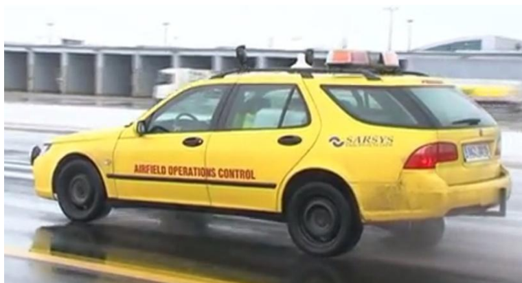
Obrázek 24: Saab 9-5 Combi se systémem Sarsys Friction Tester [14]
