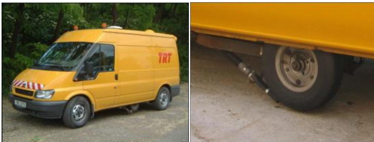
Obrázek 23: Ford Transit s nástavbou TRT s detailem měřícího kola [13]
