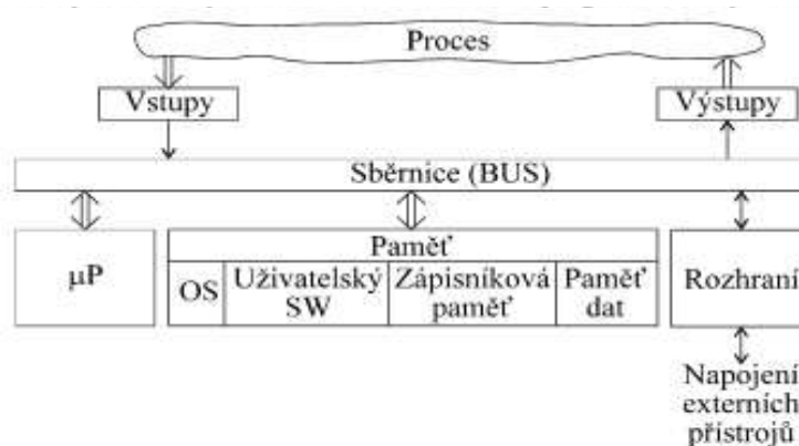
Obr. 1.1 – Blokové schéma modulárního PLC (Zezulka et al., 2003, s. 7-16)
