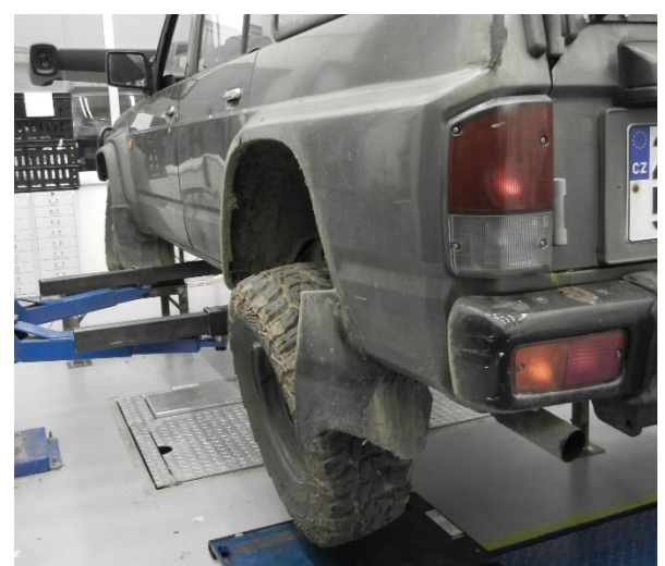
Obrázek 12: Průběh měření úhlů náprav vůči sobě při křížení. Vlevo: upravený. Vpravo: sériový.
