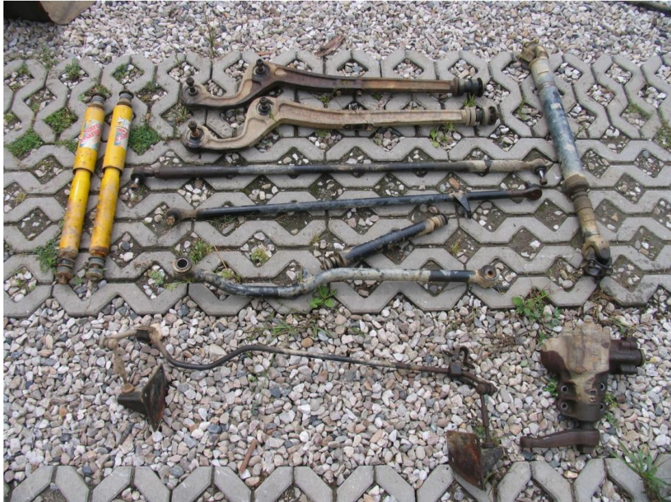
3. díly z přední nápravy (Shora: ramena, spojovací tyč řízení, tyč řízení, panhardská tyč, tlumič řízení, stabilizátor. Vpravo: kloubová hřídel, převodka řízení. Vlevo: tlumiče)
