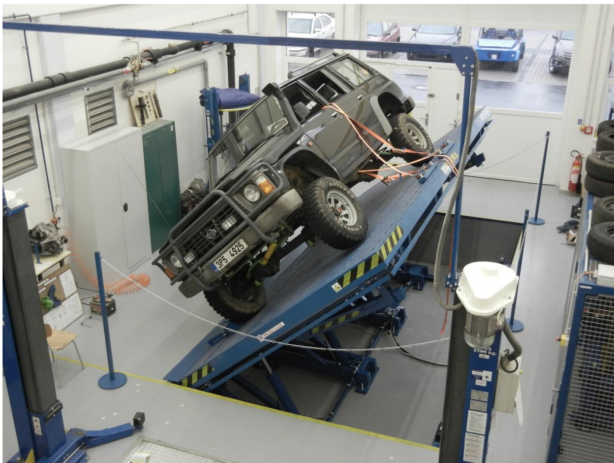
20. měření úhlu překlpení vozidla na sklopné plošině (upravený vůz se překlápí při 41°)
