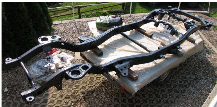
Obrázek 4: Žebřinový nosný rám s krycími ochrannými nátěry.
