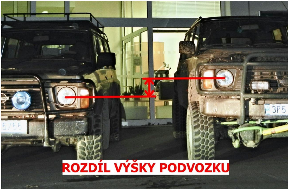
17. rozdíl výšek mezi upraveným a sériovým vozem (upravený vůz je vyšší o 12 cm)
