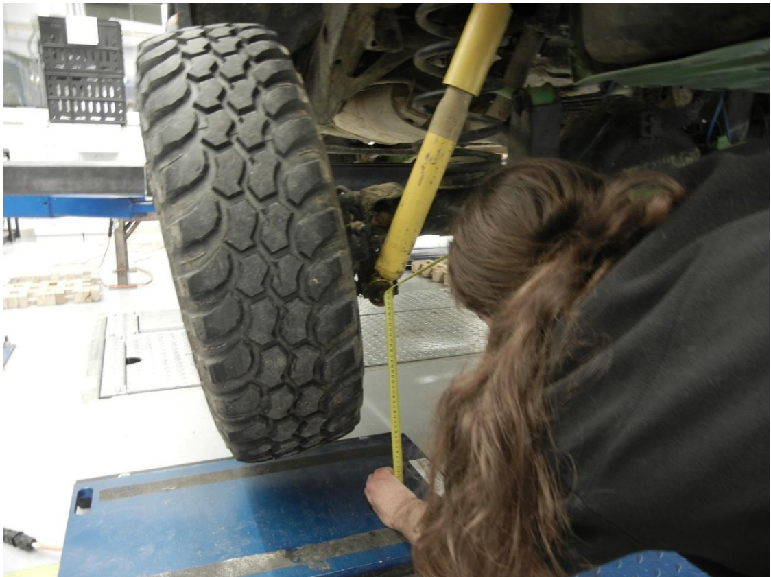
24. průběh měření úhlů vykřížených náprav
