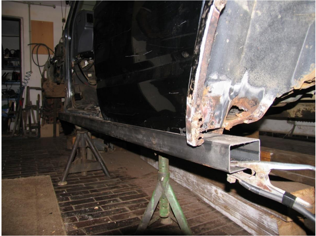
5. pevnostní prahy, jekl 100x60mm
