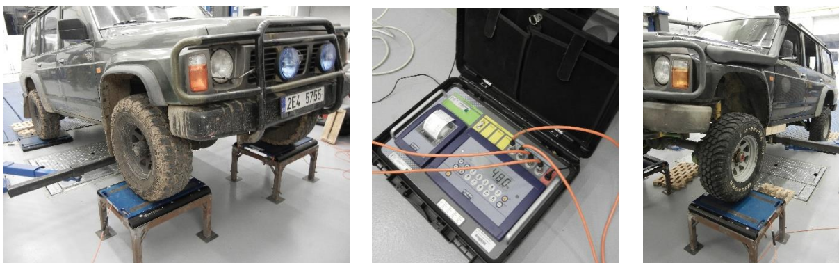
Obrázek 9: Průběh měření. Vlevo: Sériové vozidlo na váhách při sklonu a. Uprostřed: Hardware vyhodnocující informace z váhových desek. Vpravo: Upravený automobil.
