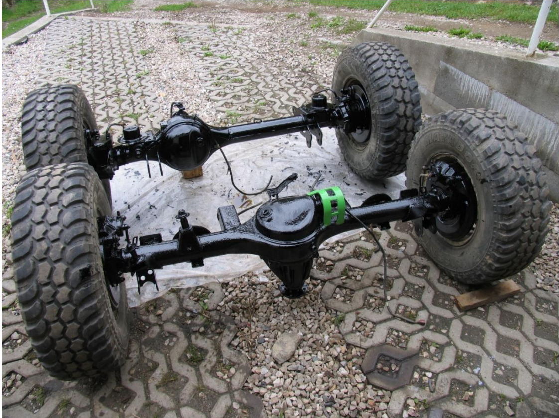
9. ošetřené nápravy s novou klecí na uzávěru diferenciálu (zelený díl)
