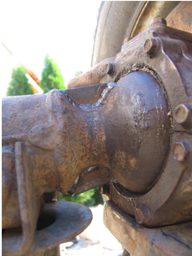
6. zesílení nápravy v nejužším místě kvůli odolnosti proti ohybu
