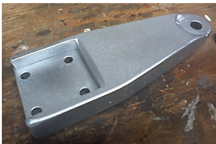
Obrázek 8: Vlevo: Nové uložení pro tyč řízení na těhlici. Vpravo: Montáž na vozidle (v dolní části je vidět původní oko na čep tyče řízení).
