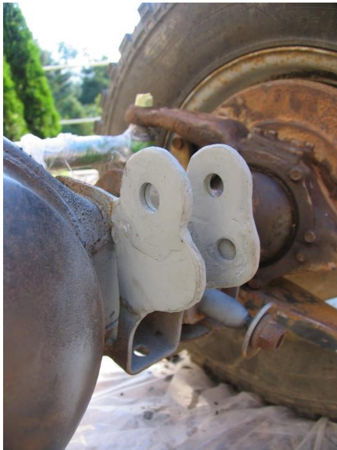
4. upravené uchycení ramen na nápravě (změna zúklonu)
