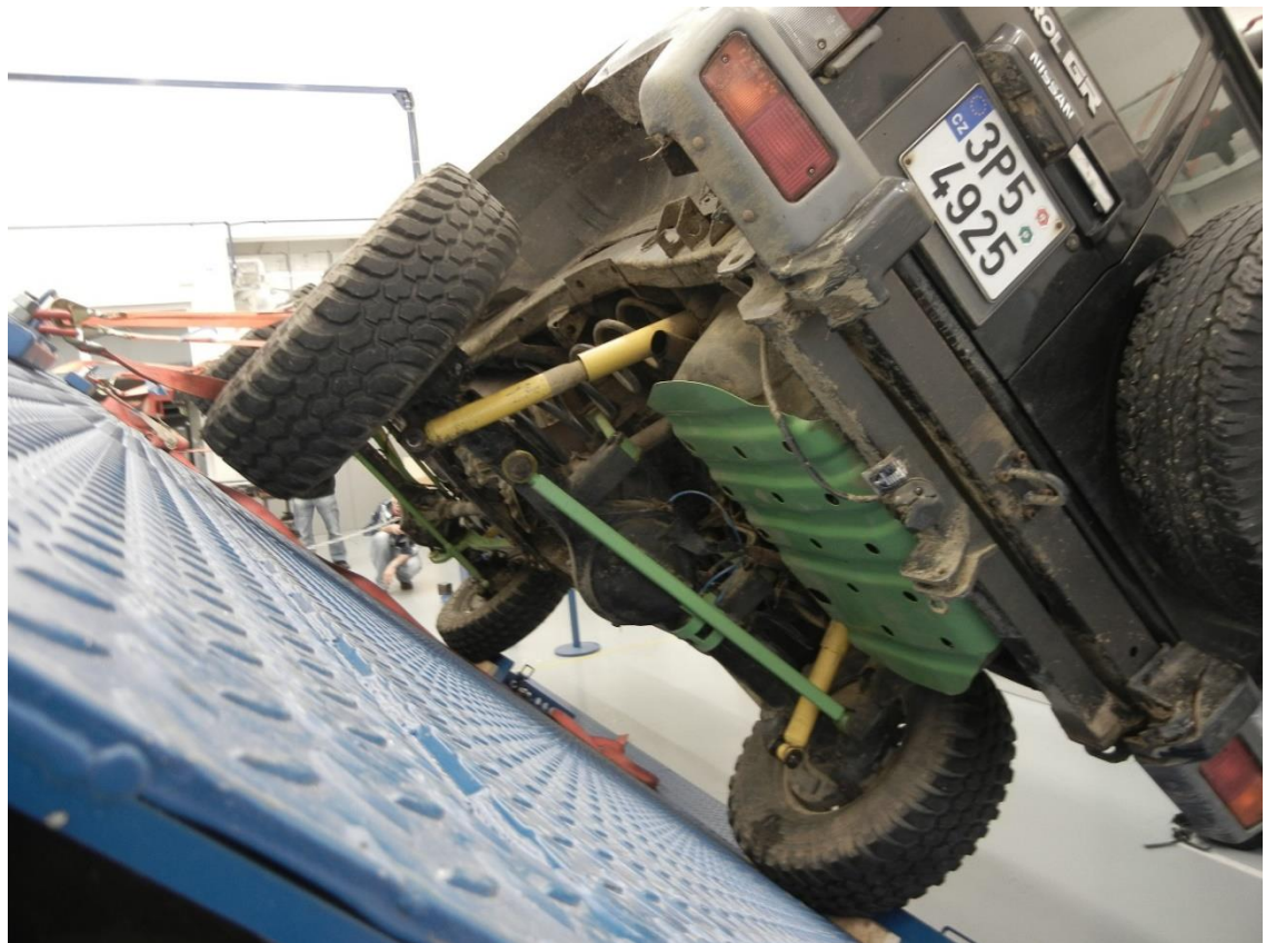
18. měření úhlu překlopení vozidla na sklopné plošině (k překlopení dochází ve 41^\circ )
