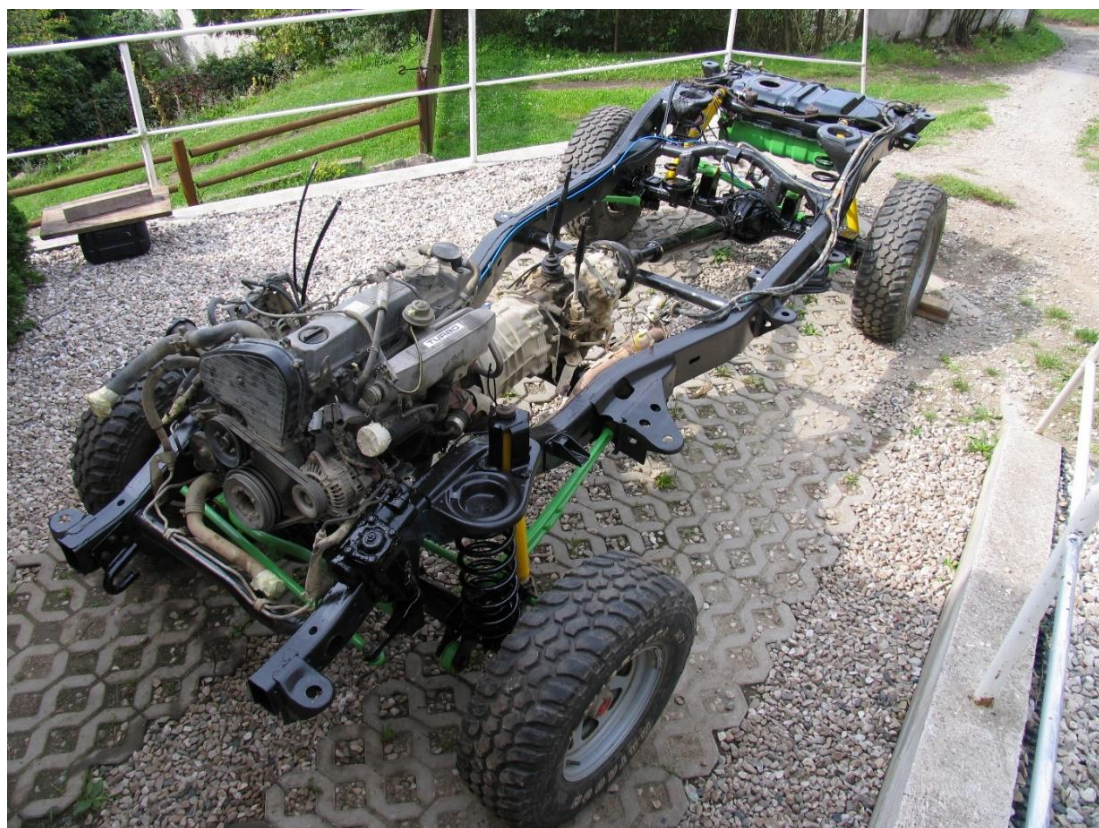
11. montáž (lze vidět nové kovové trubky na brzdovou kapalinu a plastové hadice na přívod/odvod pohonných hmot, dále hadice na podtlak do uzávěry diferenciálu a odvodu nápravy)
