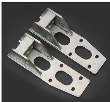
Obrázek 3: Relokace předních ramen na Nissan Patrol GR Y60. [8]
