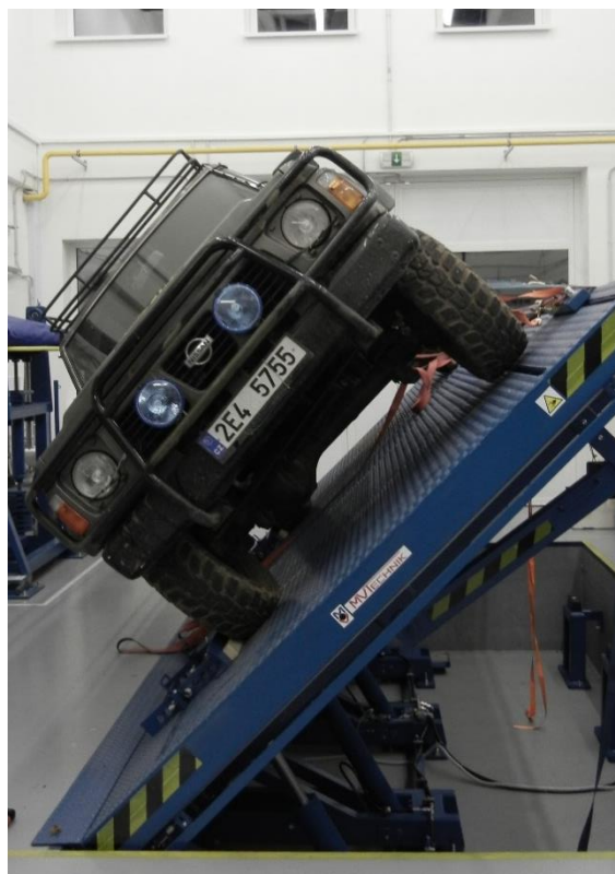
Obrázek 11: Měření úhlu překlpení. Vlevo: Upravený automobil. Vpravo: Sériový automobil.
