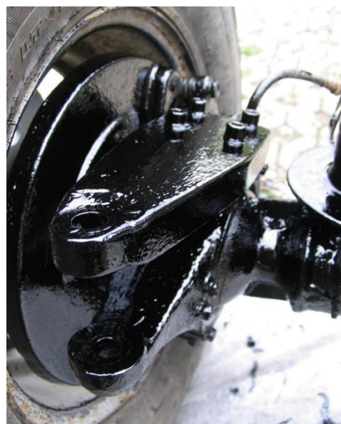
Obrázek 8: Vlevo: Nové uložení pro tyč řízení na těhlici. Vpravo: Montáž na vozidle (v dolní části je vidět původní oko na čep tyče řízení).
