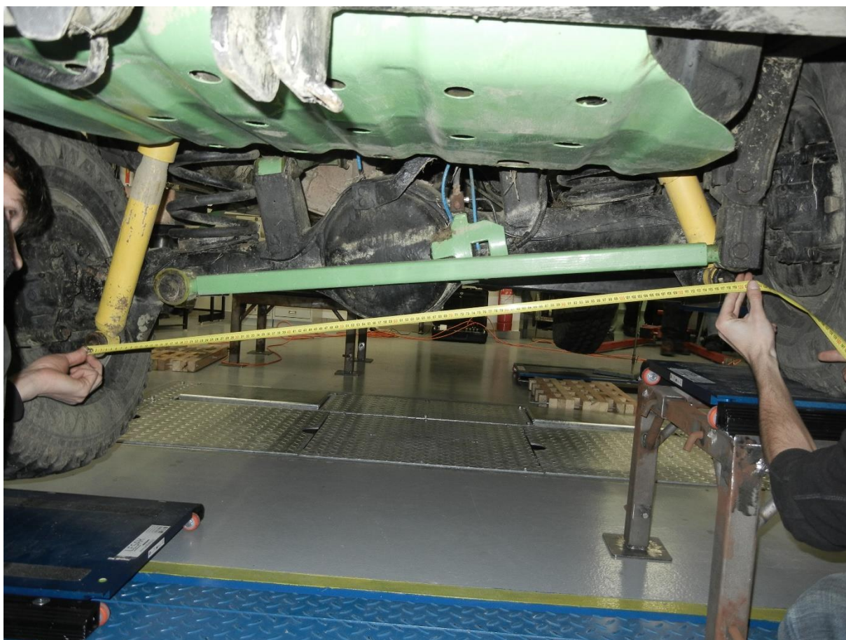
23. průběh měření úhlu vykřížených náprav
