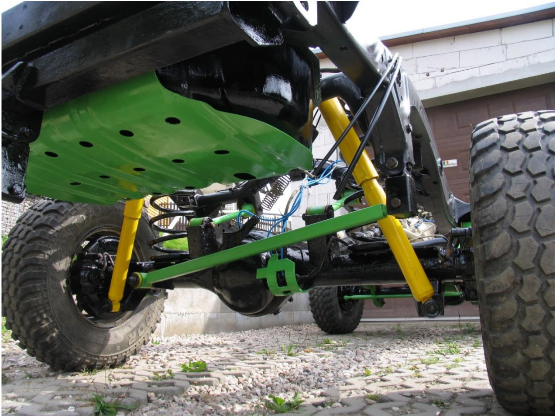
10. montáž (ošetřené veškeré díly + instalace nových tlumičů a pružin)
