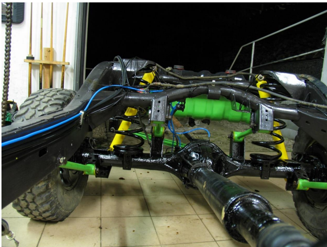
11. montáž (lze vidět nové kovové trubky na brzdovou kapalinu a plastové hadice na přívod/odvod pohonných hmot, dále hadice na podtlak do uzávěry diferenciálu a odvodu nápravy)
