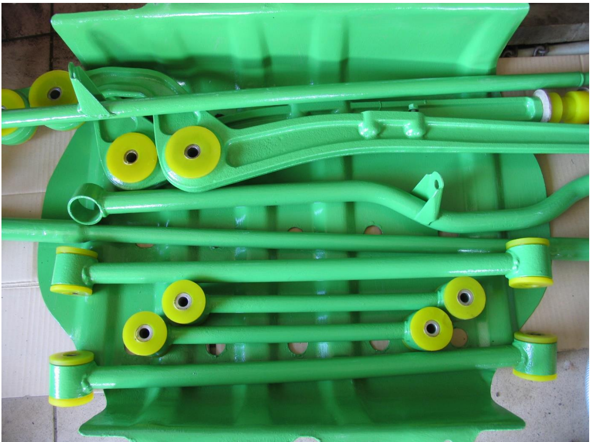
8. vsazené polyuretanové silentbloky
