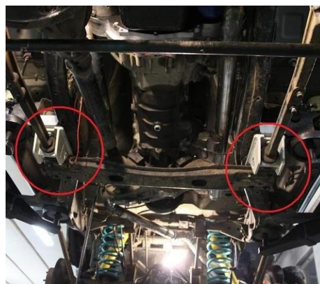
Obrázek 3: Relokace předních ramen na Nissan Patrol GR Y60. [8]
