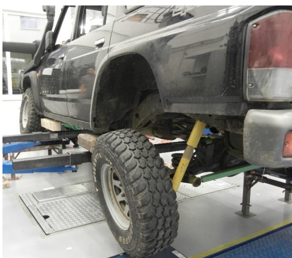
Obrázek 12: Průběh měření úhlů náprav vůči sobě při křížení. Vlevo: upravený. Vpravo: sériový.
