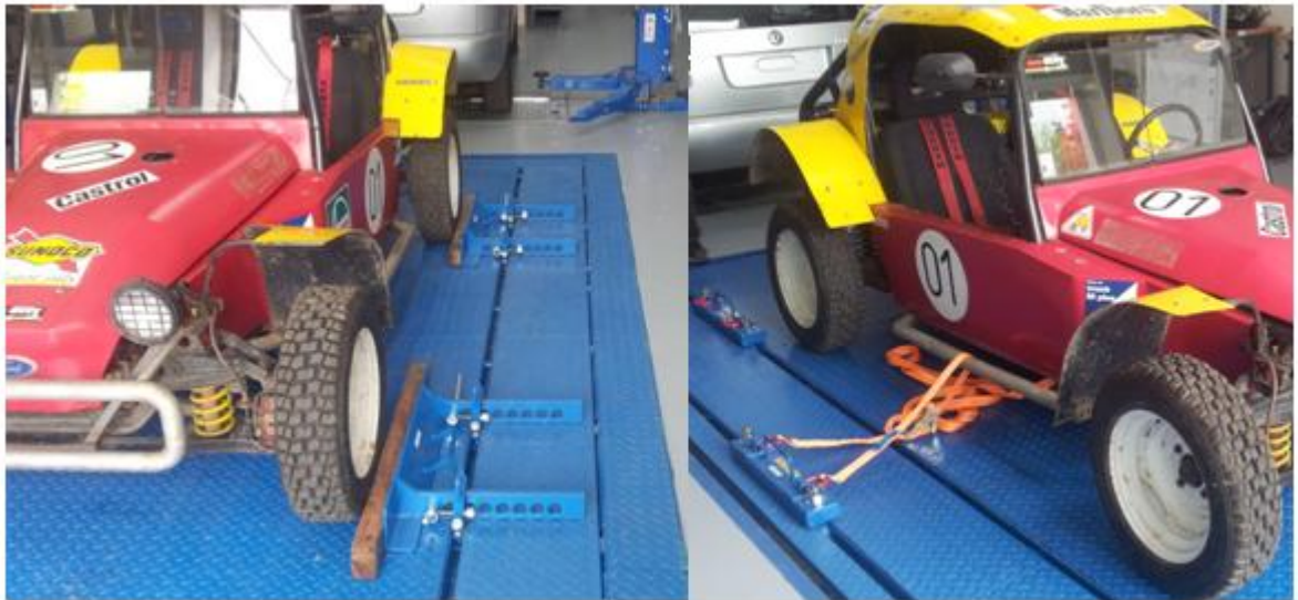
Obrázek 14 Opěrná a jistící místa vozidla
