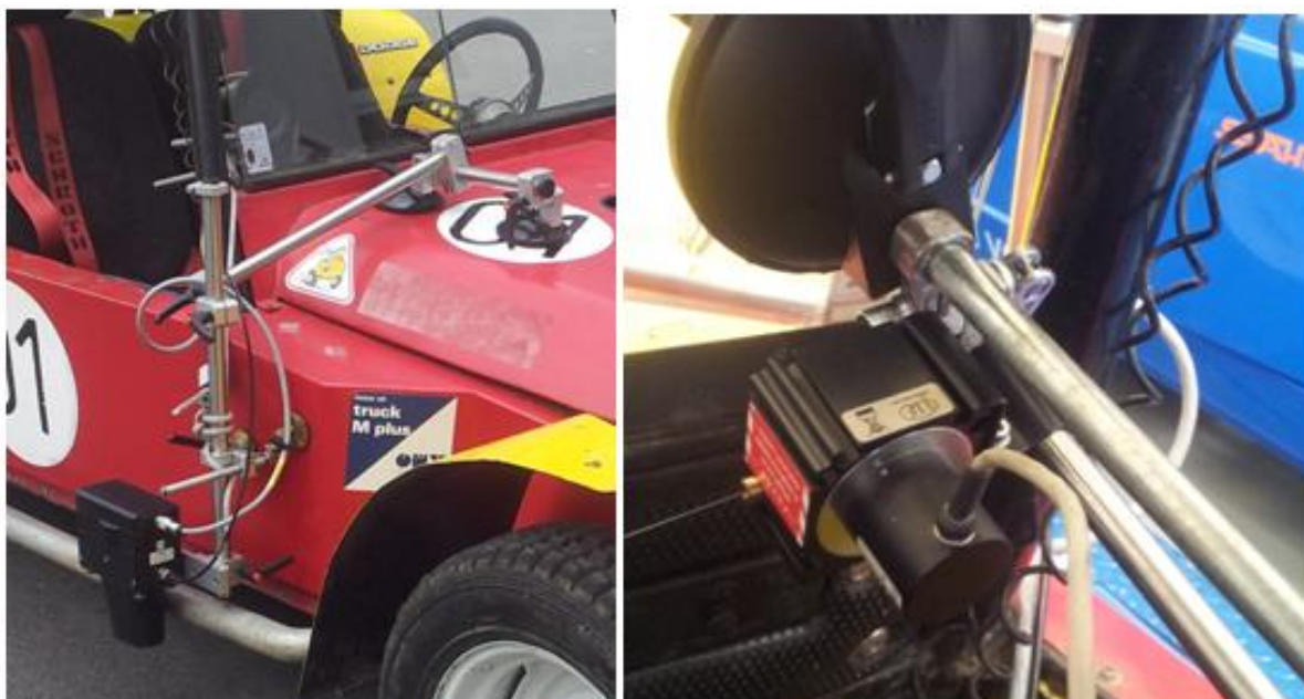
Obrázek 17 Upevnění snímačů na vozidle
