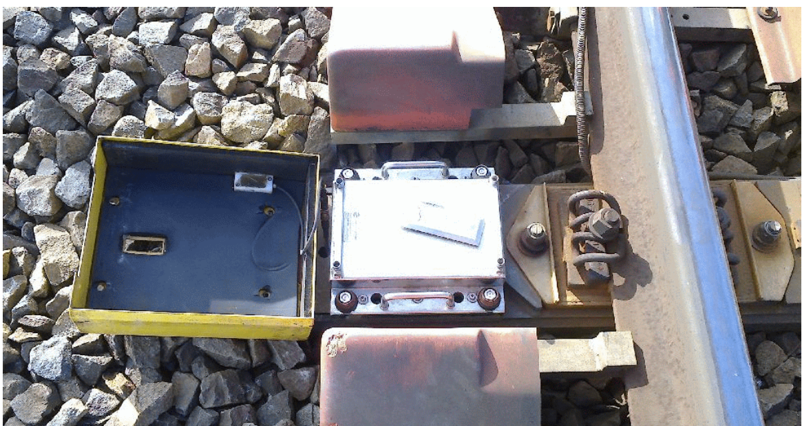
Obr. 10 Snímač IHL systému PHOENIX se sejmutým vrchním krytem
