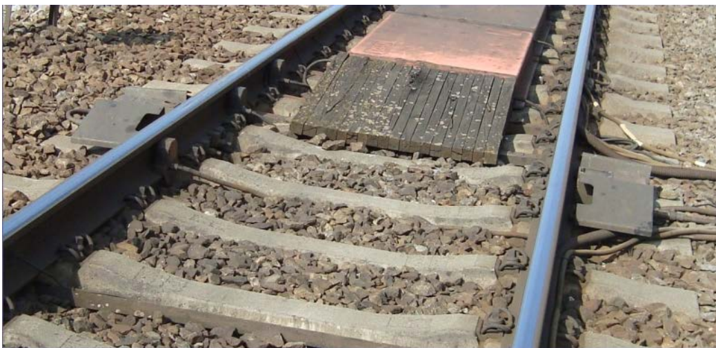
Obr. 9 Snímače IHL po obou stranách koleje
