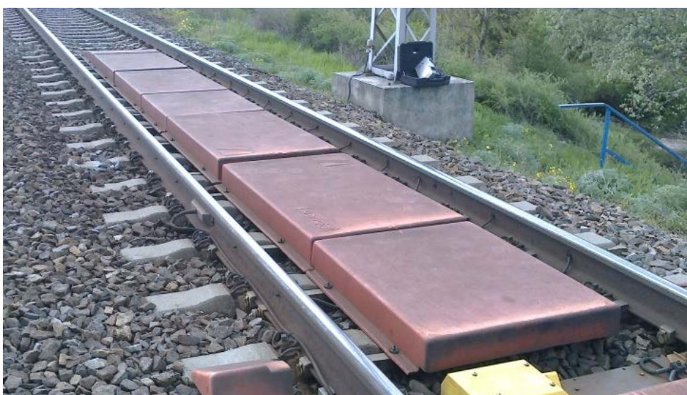
Obr. 13 Snímače měření závad na pojezdu drážních vozidel
