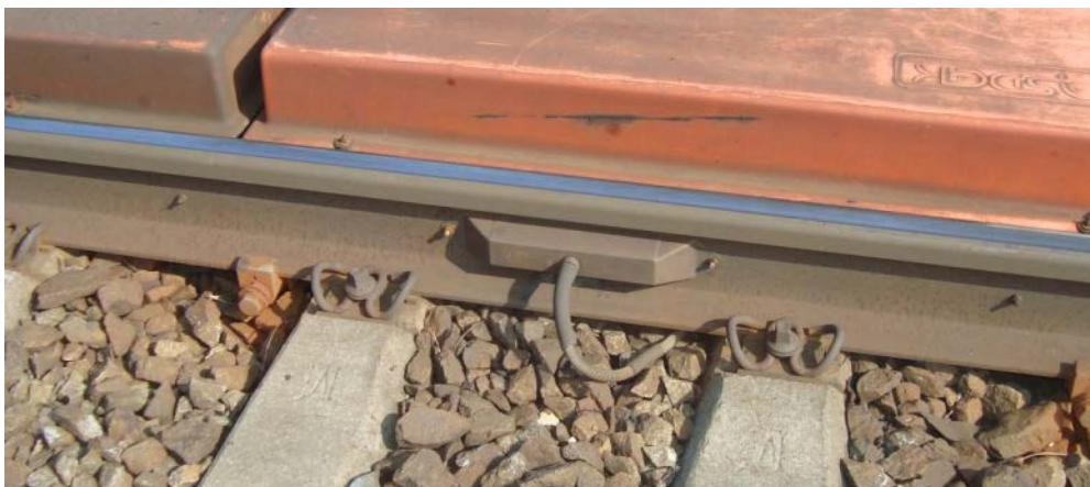
Obr. 15 Tenzometrický snímač tlaku kola
