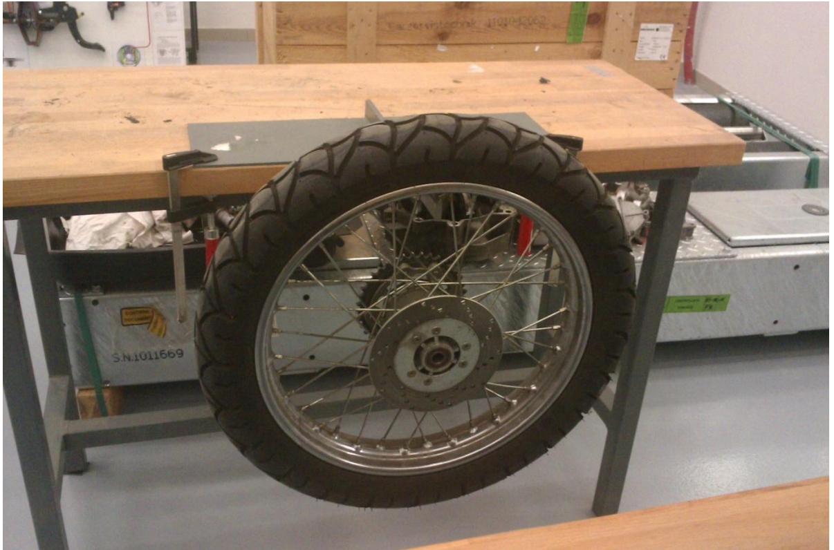
Obrázek 11: Odkývání zadního kola na trnu
