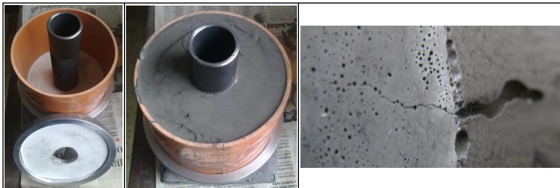
Obr. 31 Vznik trhlin během zrání
