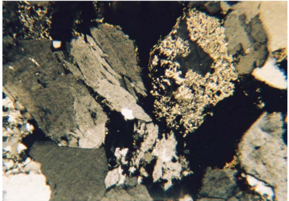
Pískovec křemenný, arkózovitý, hrubozrnný, slabě silicifikovaný vzorek NMR, socha P. Marie, zvětšení 32x, nikoly X hrubozrnné křemenné a živcové klasty, degradace živcových zrn (sericitizace)
