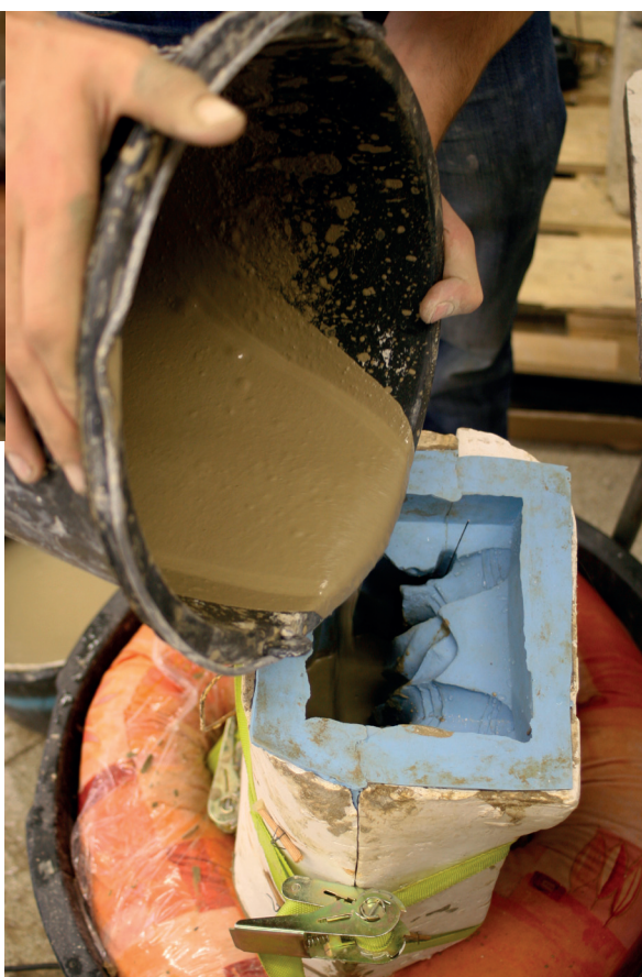
obr. 41 Lití směsi románského cementu s kamenivem
