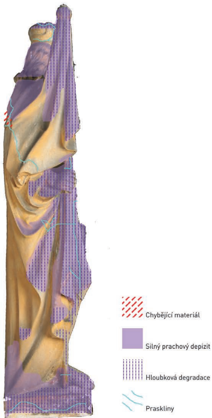
obr. 65 Zákres poškození, pravá
