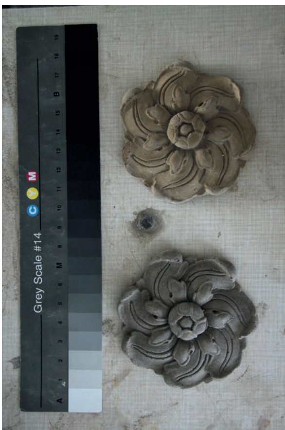
obr. 49 Zkoušky barevnosti v průběhu tvrdnutí, rozdíl 1 hodina od odformování
